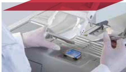
明亮的白色 LED 照明能够有效地提升样品的对比度和**可见度**，特别是那些透明、半透明的组织。易于调节的放大镜能够**轻松定位**到最合适观察的位置，帮助您包埋较小、复杂的**活检样品**。
