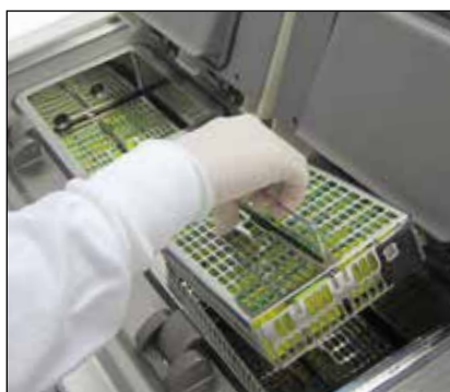
デュアルレトルトにより連続処理が可能
