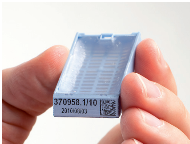
Cassette Leica LP C après infiltration des tissus et enrobage d'un échantillon
