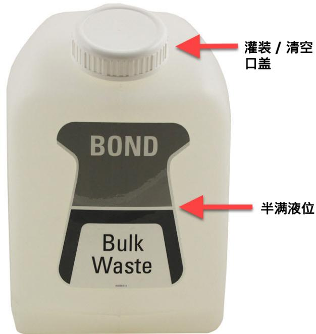
图 125: BOND-MAX9L 外部标准废液容器
