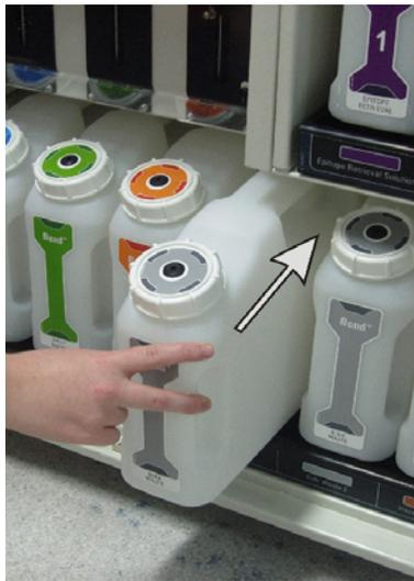
图 123: 将废液容器放回其原先所在位置。
