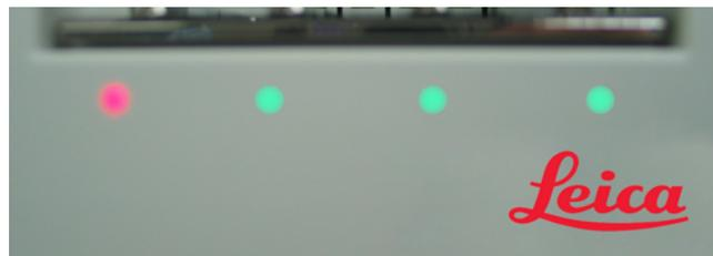
图 14：当前型号的 BOND-MAX 仪器的试剂架指示灯颜色（红色、绿色）
