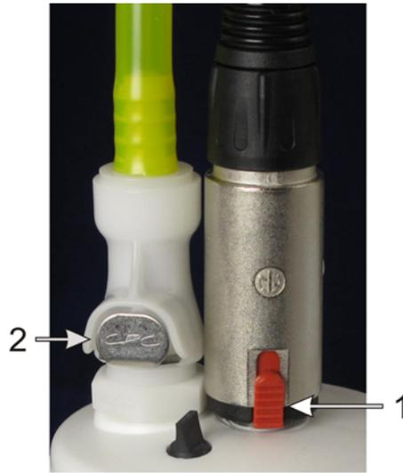
图 126: 外部废液容器连接: 左边为液体接口, 右边为液位传感器接口
