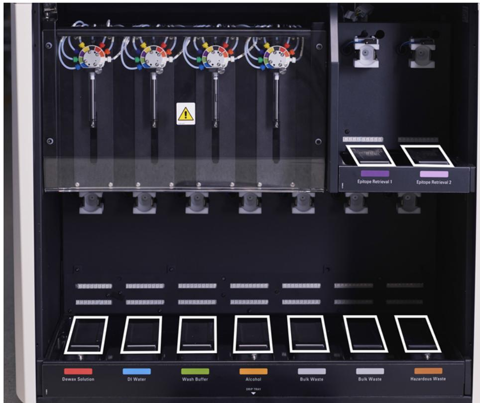
图 141：BOND-III 大容器承滴盘及重量传感器护盖
