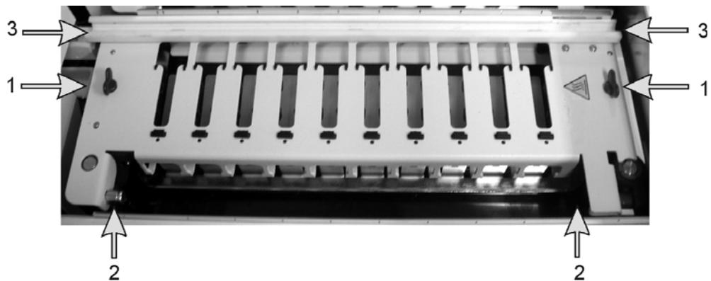
图 128: BOND-III 盖板, 可见紧固钮 (1)、铰链 (2) 和大用量液流自控装置导轨 (3)
