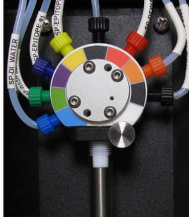
图 24: BOND-MAX 9 孔注射器
