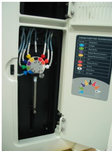
图 6: 铰链门后面的注射器
