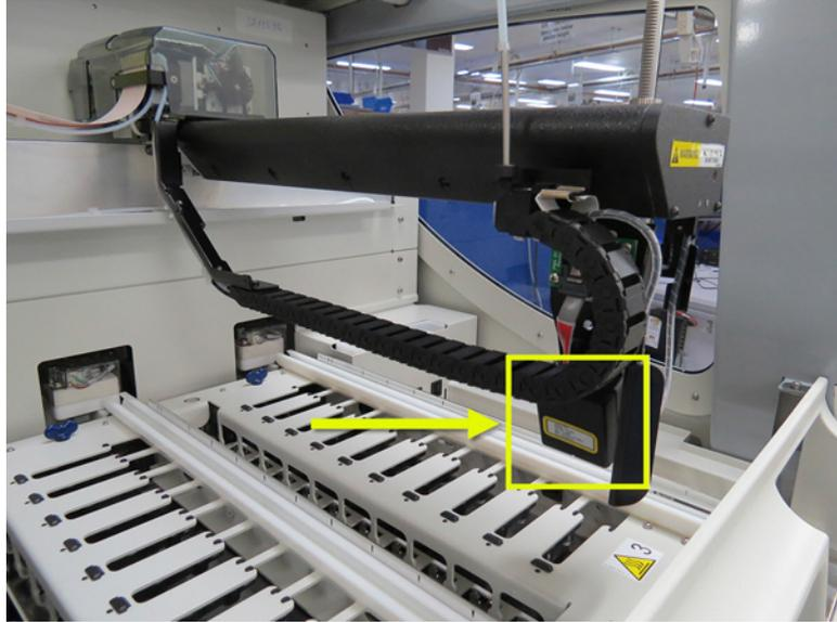
图 7: 主自控装置图片, 箭头所指为 ID 扫图仪
