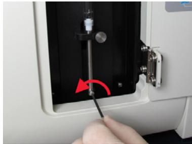
图 145：用内六角扳手拧开柱塞止动螺钉
