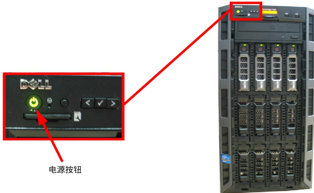
图 154: 电源按钮在控制器前面板上的位置（面板防护罩已取下）
