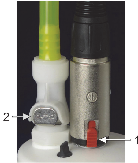
圖 126: 外部廢液容器: 左邊是液體接頭, 右邊是液位感應器接頭
