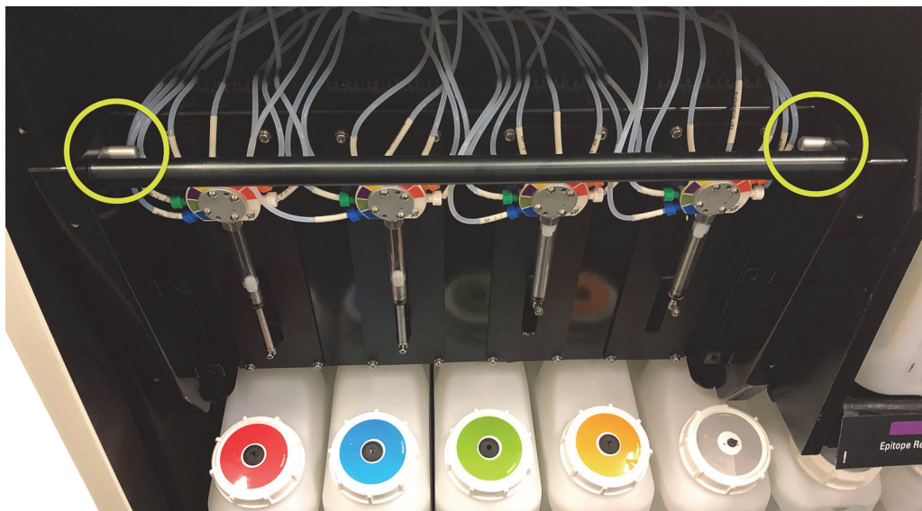
圖 131: 裝置打開狀態下的釋放插銷位置
