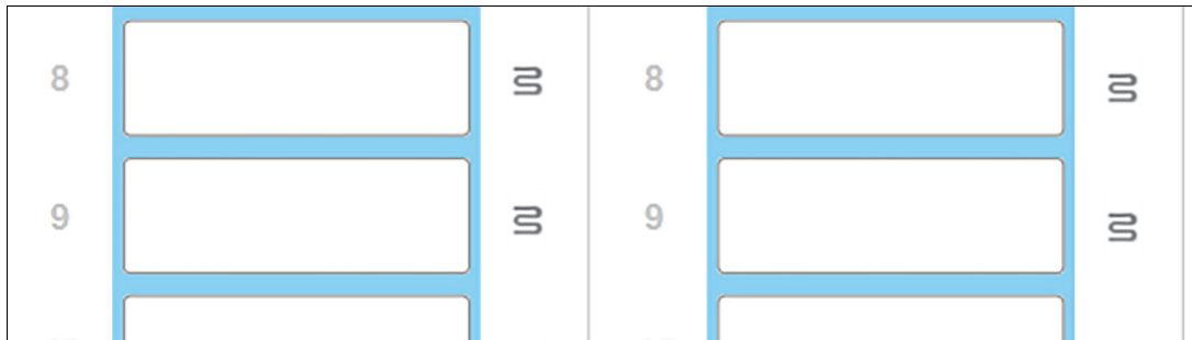
圖 9: 各位置的灰色加熱器符號表示完全關閉加熱
