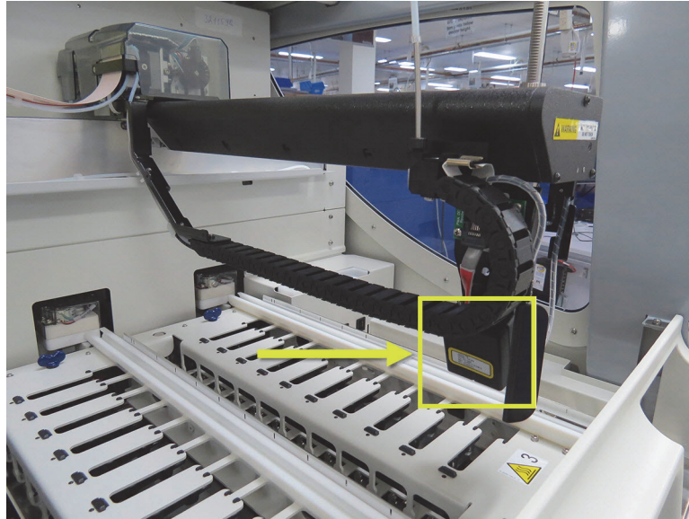
圖 7: 機械臂的相片，箭頭所指處為 ID 成像器
