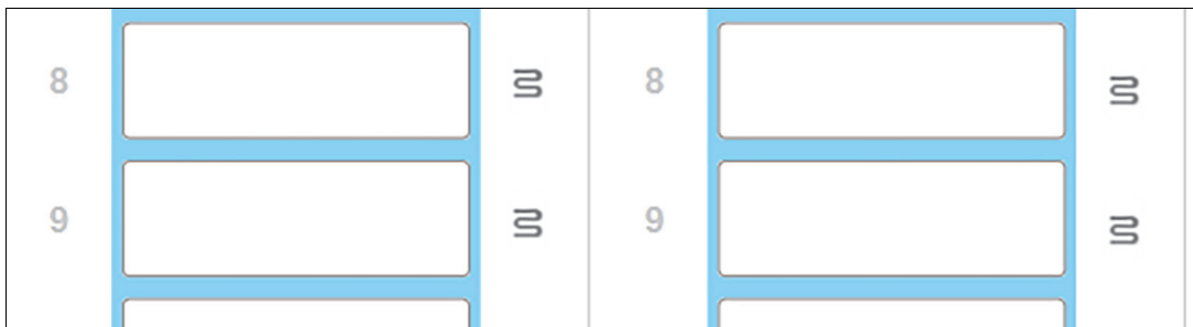
圖 50: 各位置的灰色加熱器符號表示完全關閉加熱
