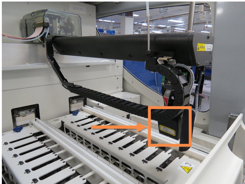
Obrázek 2-7: Fotografie hlavního robotu se snímačem ID (oblast označená šipkou)
