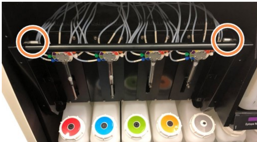
Figure 12-9: Umístění uvolňovacích šroubů s otevřenou jednotkou pro přístup
