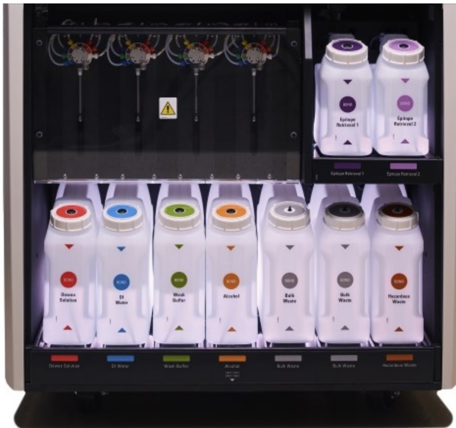
Obrázek 2-16: System světelné indikace stavu velkých nádob
