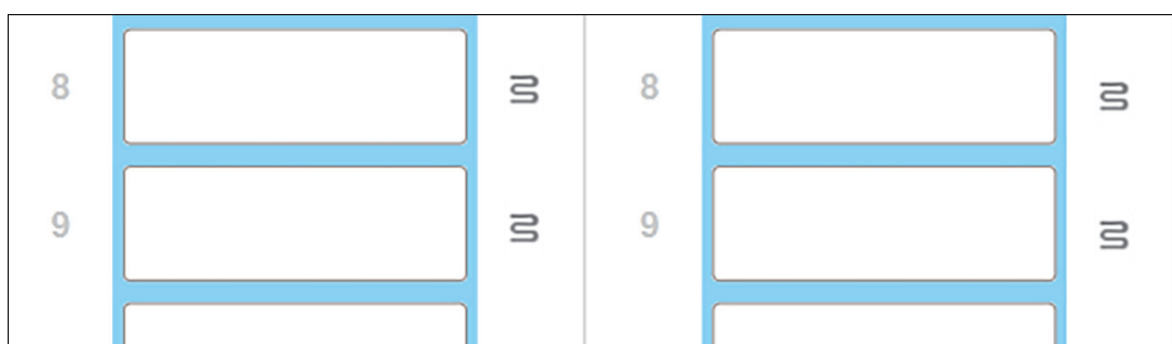
Figuur 9: Grijs verhittersymbolen op elke positie geven een complete uitschakeling van de verhitting aan
