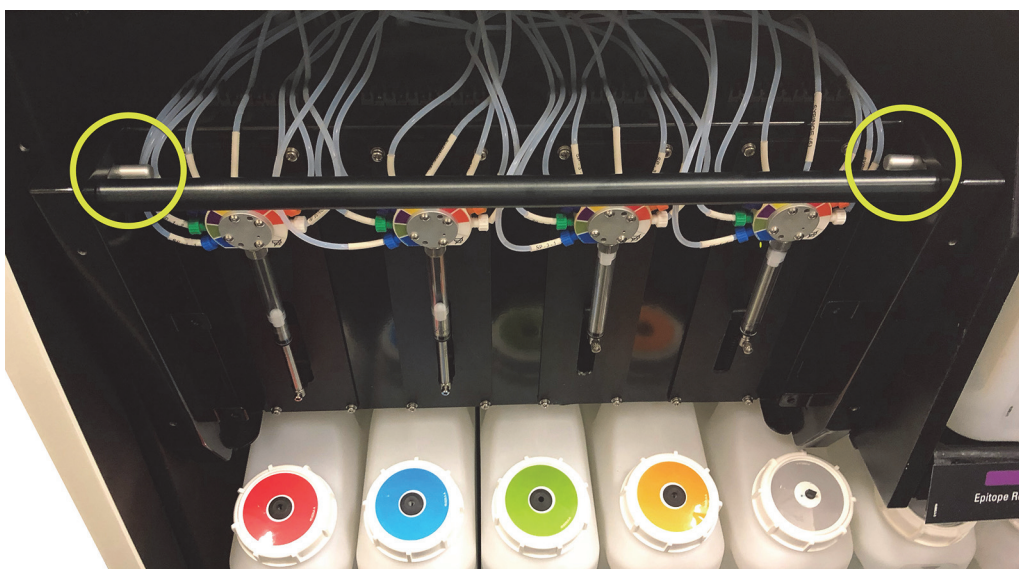
Figuur 131: Plaats van ontkoppelingspennen in geopende unit voor meer toegang
