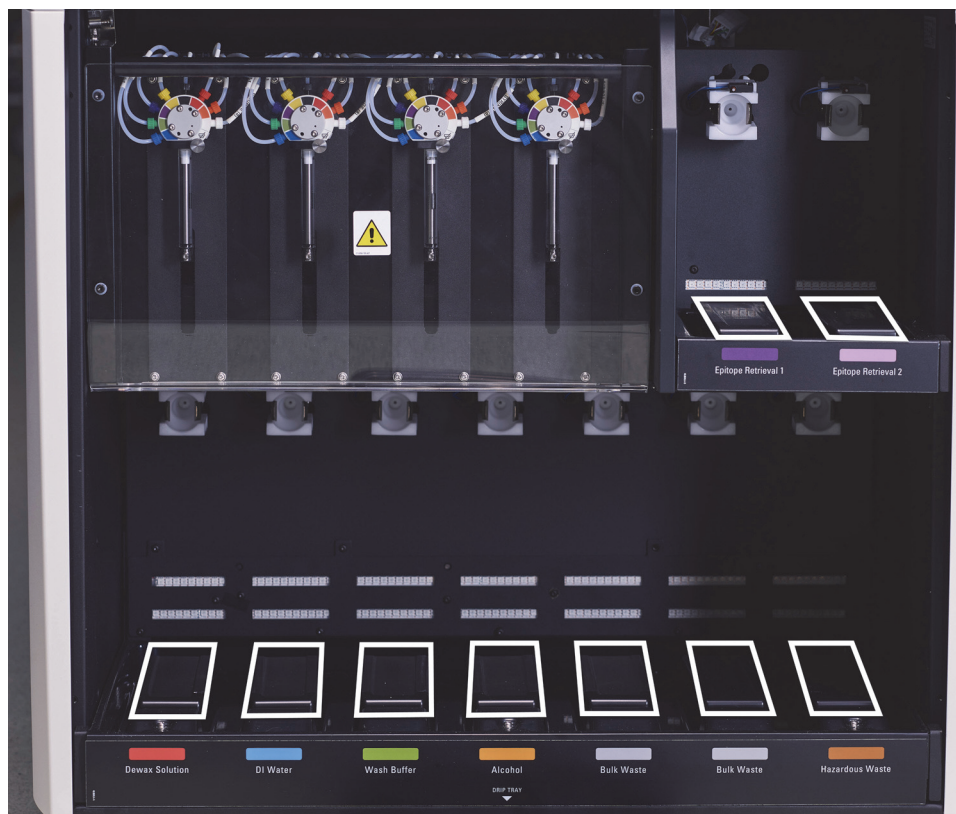
Figuur 137: BOND-III-bulkcontainer lekbakken met de platen over de gewichtssensoren
