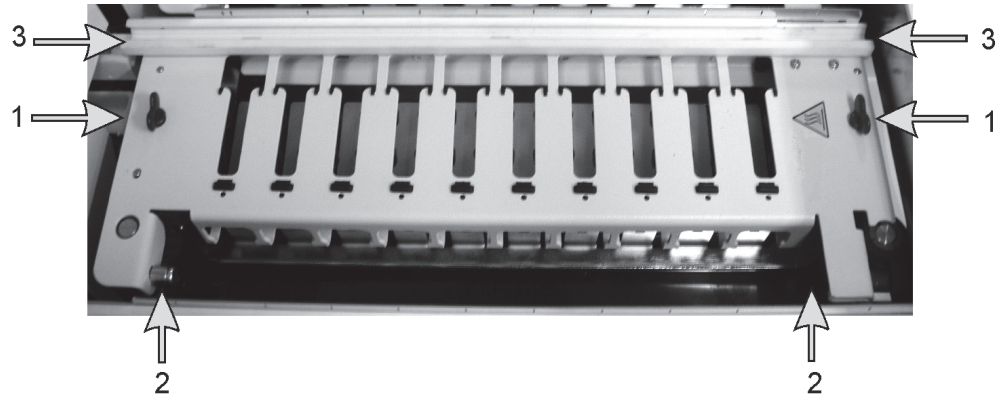
Figuur 128: BOND-III bovenplaat met draaibevestigers (1), draaipennen (2) en de geleiderails van de bulkvloeiëstrobot (3)
