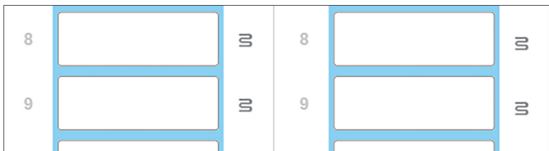
Figuur 50: Grijs symbolen van verwarmingselementen op elke positie geven een complete uitschakeling van de verhitting aan
