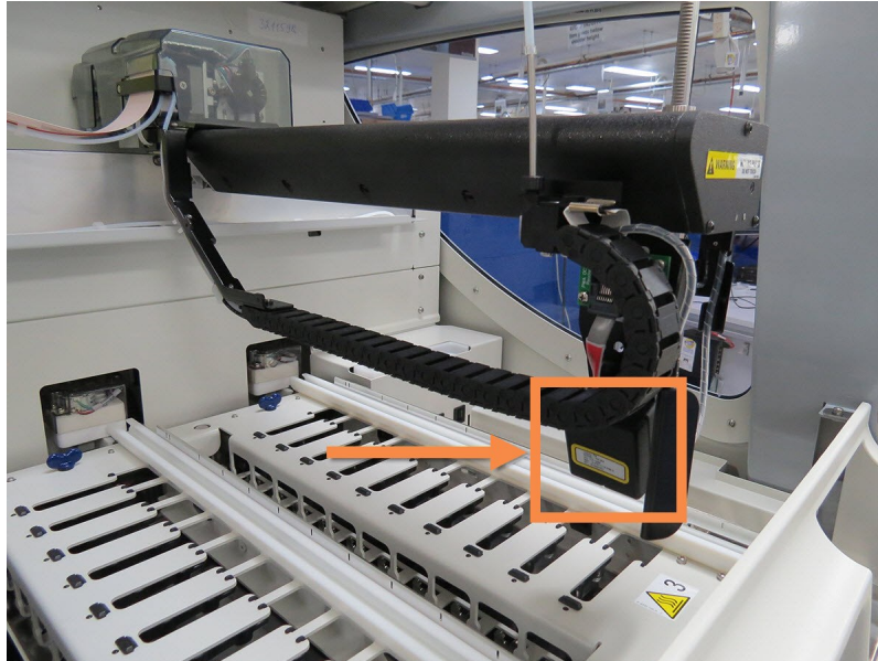
Kuva 2-7: Päärobotti; tunnisteiden kuvantaja osoitettu nuolella
