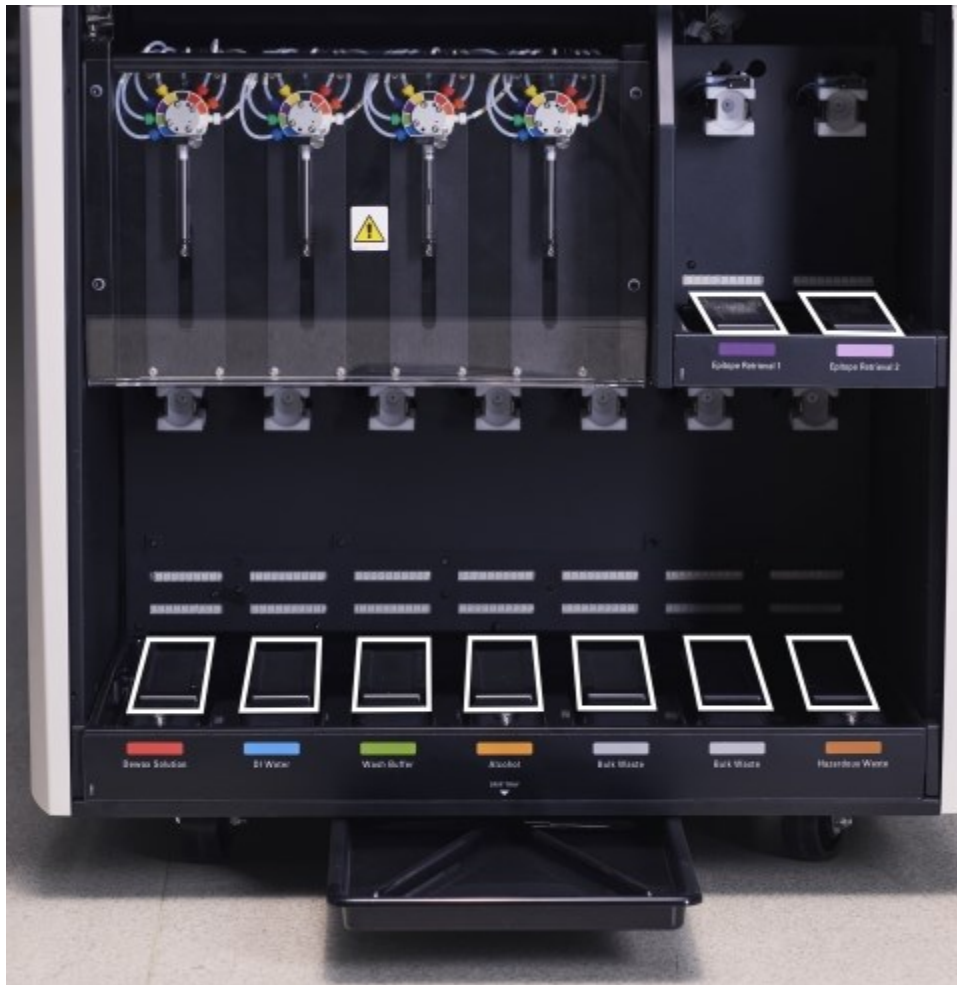
Figure 12-15: BOND-III-bulkkisäiliön tippatelineet sekä painoanturin suojuukset
