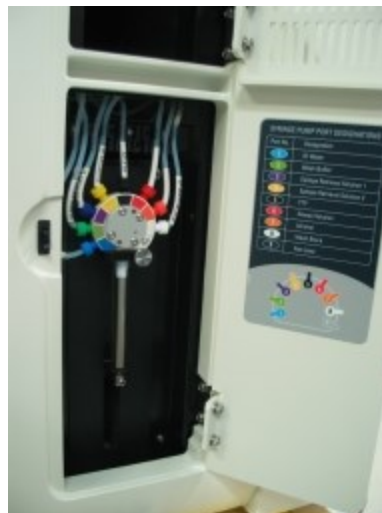
Kuva 2-6: Ruisku saranallisen luukun takana
