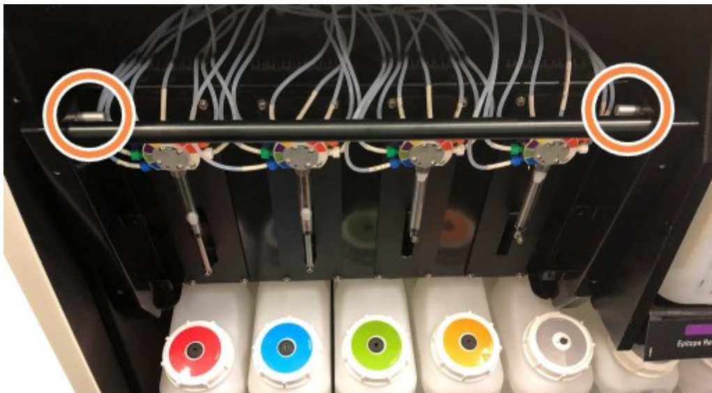
Figure 12-9: Vapautustappien sijainti laitteen ollessa auki
