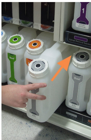
Kuva 12-1: Jätteen astian palauttaminen paikalleen
