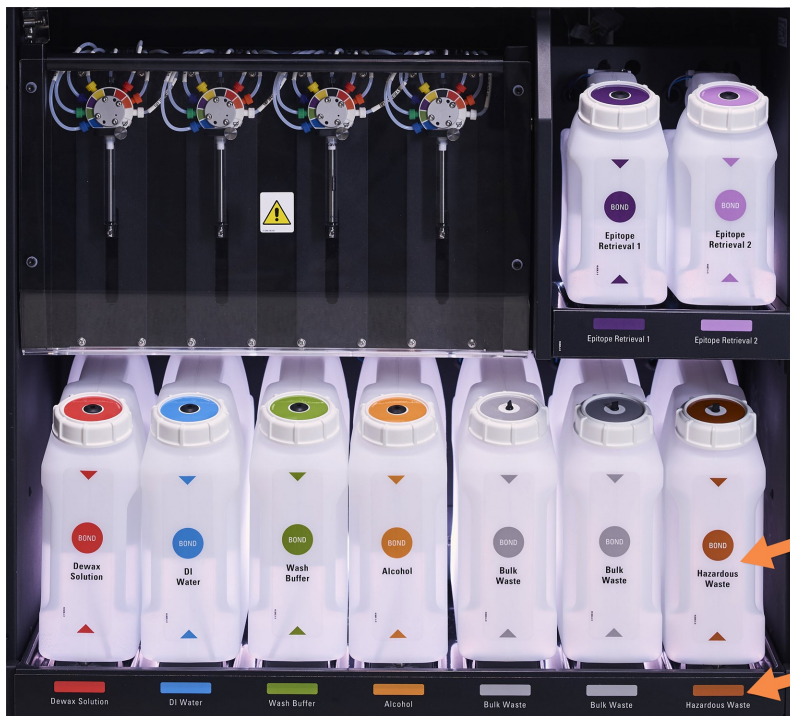
Kuva 2-15: BOND-III-bulkkireagenssisäiliöt omilla paikoillaan
