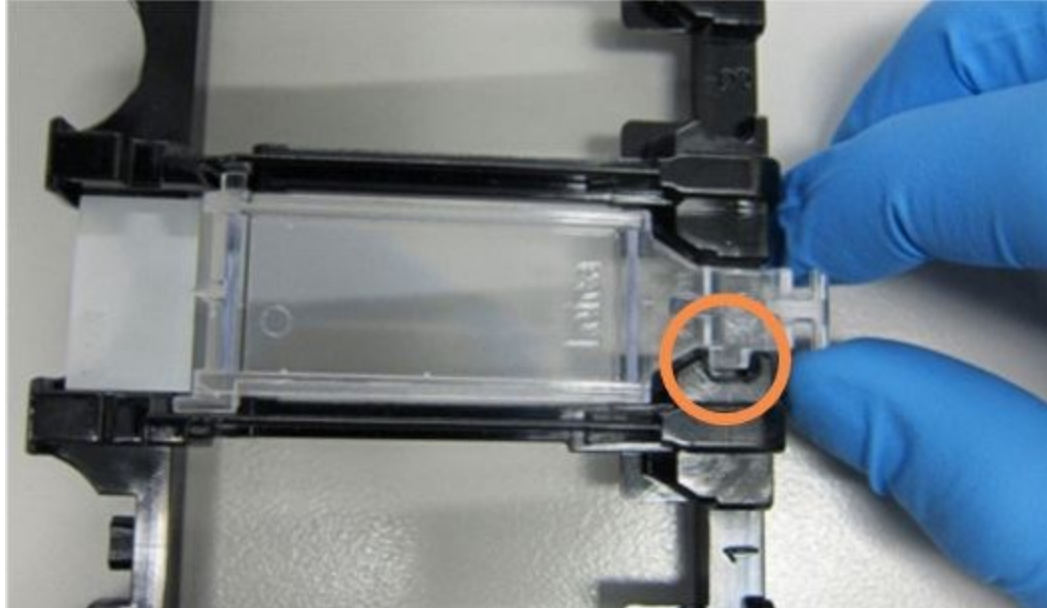
Figure 4-6: Covertile-suojuksen asettaminen leikkeen päälle
