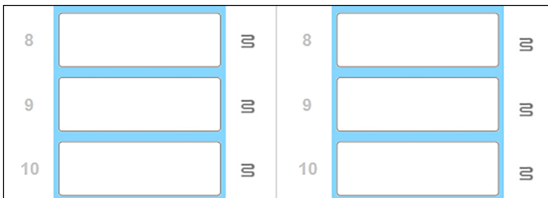
Kuva 5-4: Kussakin sijainnissa olevat harmaat kuumenninsymbolit ilmoittavat, että kaikki kuumentimet ovat poissa päältä
