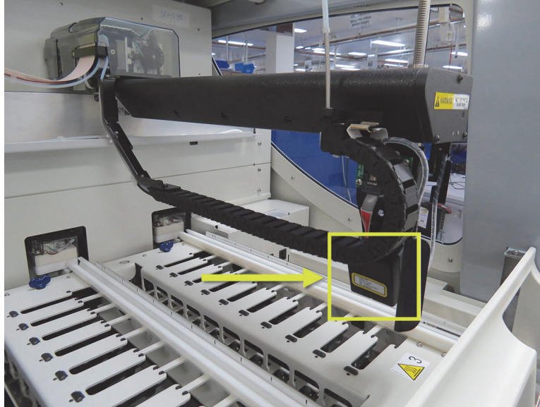
Abbildung 7: Abbildung des Hauptroboters mit dem durch einen Pfeil gekennzeichneten ID-Imager
