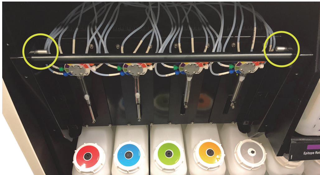
Abbildung 131: Position der Freigabebolzen bei zugänglicher offener Einheit
