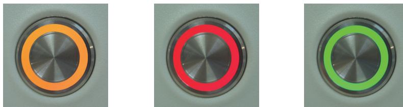
Abbildung 13: LED-Farben für die Objektträgeraufnahme (orange, rot, grün) beim BOND-MAX-Gerät.
