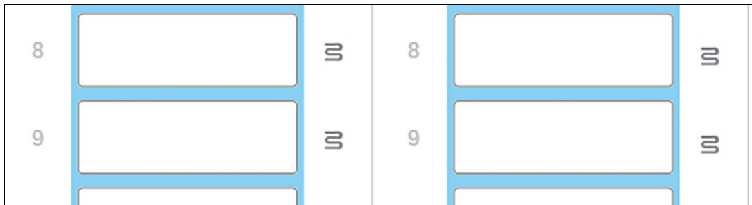
Abbildung 50: Wenn auf allen Positionen graue Heizelemente erscheinen, wurde die Heizung komplett abgeschaltet.
