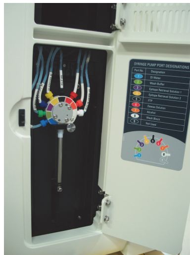
Abbildung 6: Spritze hinter der Klappe
