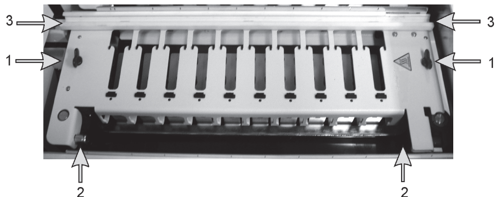
Abbildung 128: BOND-III-Deckenplatte mit Drehverschlüssen (1), Scharnierzapfen (2) und Vorratsflüssigkeitsroboterschiene (3)
