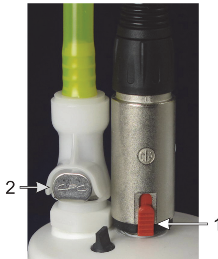
Abbildung 126: Externe Abfallbehälteranschlüsse: Flüssigkeitsanschluss links, Flüssigkeitspegelsensoranschluss rechts
