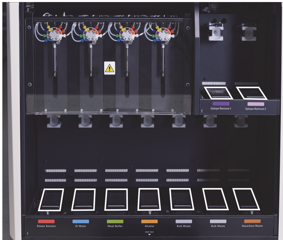
Abbildung 137: BOND-III-Auffangschalen für Vorratsbehälter mit Abdeckung der Gewichtssensoren
