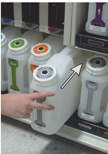
Σχήμα 123: Επανατοποθέτηση του δοχείου αποβλήτων στη θέση του
