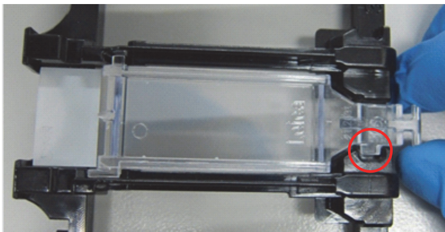
Σχήμα 44: Τοποθέτηση ενός Covertile σε πλακίδιο
