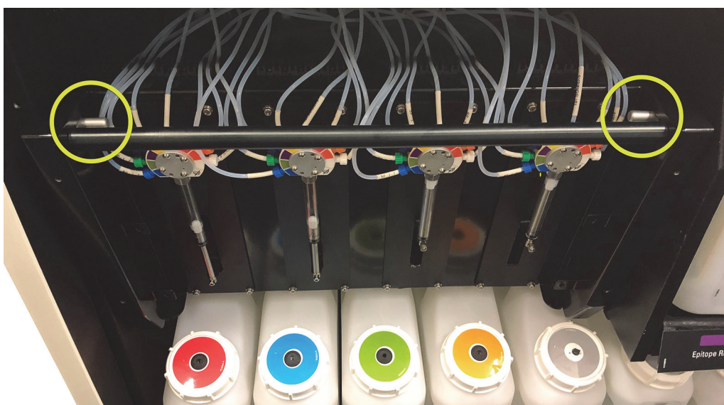
Σχήμα 131: Εντοπισμός των πύρων απελευθέρωσης με τη μονάδα ανοικτή για πρόσβαση
