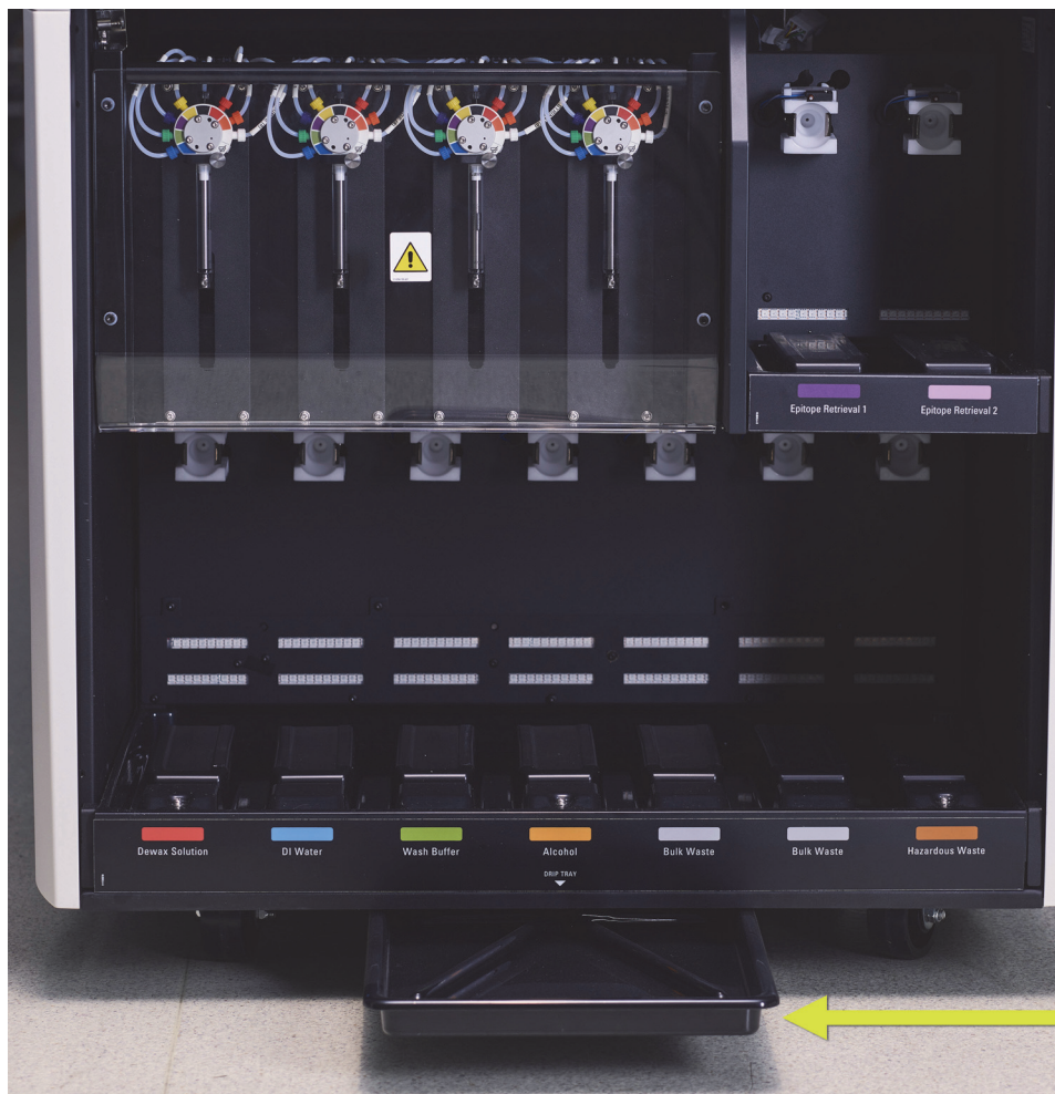
Σχήμα 142: Ο δίσκος συλλογής διαρροών του μηχανήματος BOND-III
