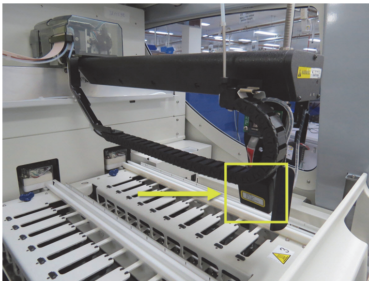
Σχήμα 7: Φωτογραφία του κύριου ρομπότ με τον απεικονιστή ID που υποδεικνύεται με το βέλος
