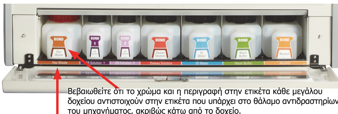
Σχήμα 17: Τα μεγάλα δοχεία αντιδραστηρίων BOND-MAX στη θέση τους
