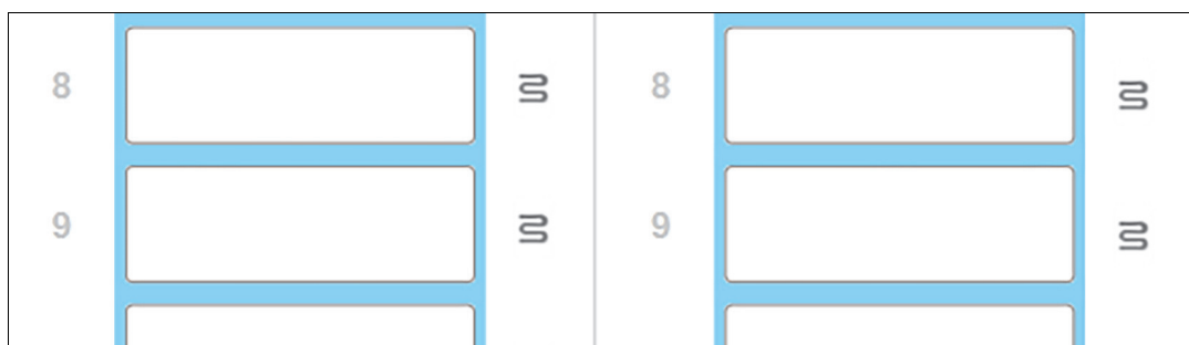
Σχήμα 9: Γκριζα σύμβολα θερμαντήρων σε κάθε θέση σημαίνουν πλήρη διακοπή της θέρμανσης
