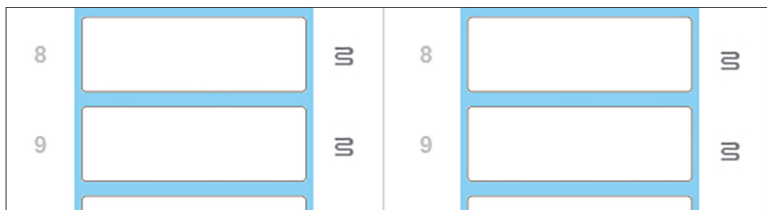
Σχήμα 50: Γκριζα σύμβολα θερμαντήρων σε κάθε θέση σημαίνουν πλήρη διακοπή της θέρμανσης
