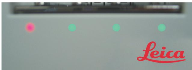
Figura 14: Colori dei LED dei vassoi reagenti (rosso, verde) sullo strumento BOND-MAX
