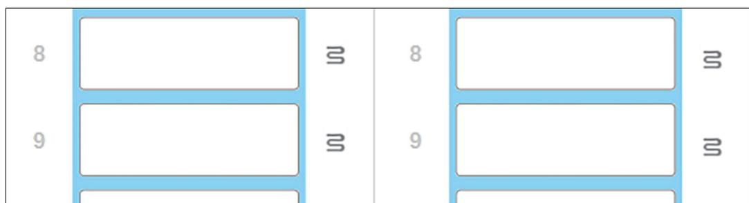
Figura 50: I simboli degli elementi riscaldanti in grigio in tutte le posizioni indicano una completa interruzione del riscaldamento
