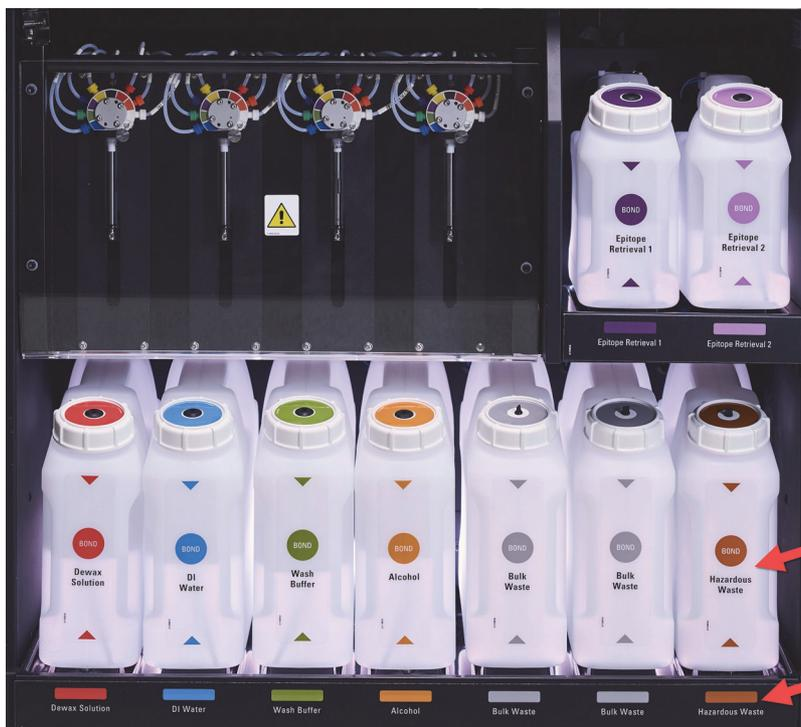
Figura 15: Contenitori dei reagenti in bulk BOND-III in posizione
