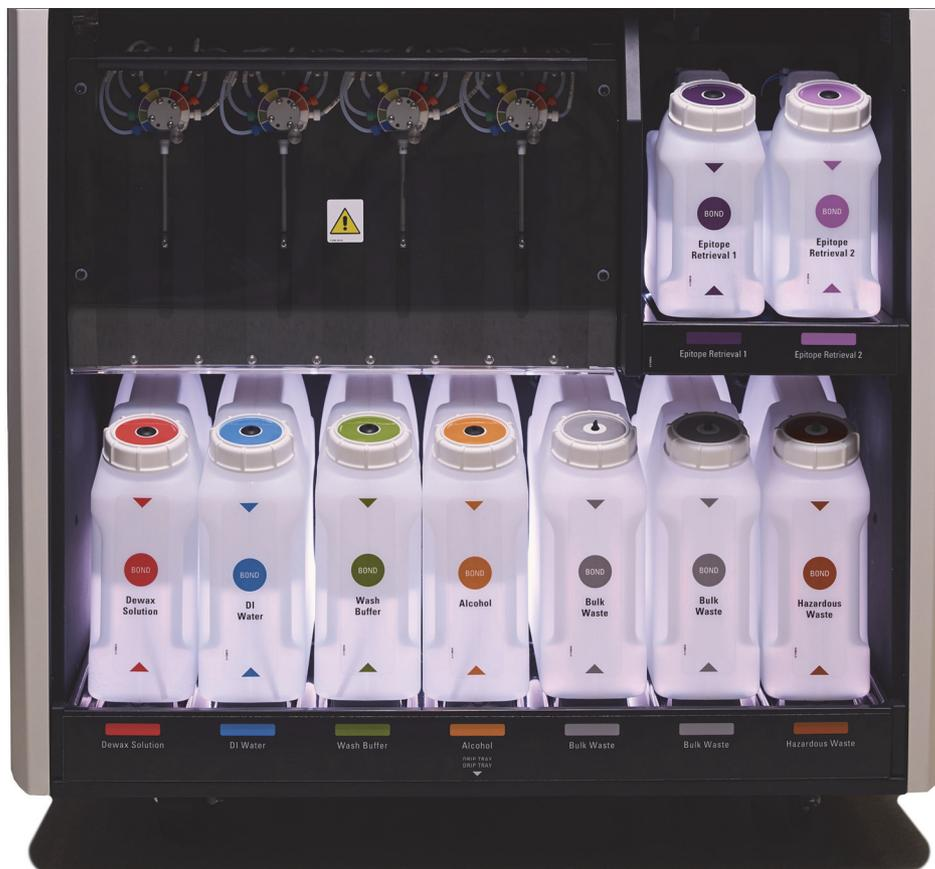
Figura 16: Sistema di illuminazione per contenitori in bulk
