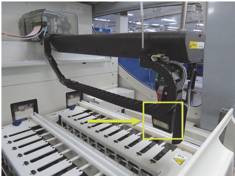
Figura 7: Immagine del braccio robotizzato principale con l'imager ID indicato dalla freccia
