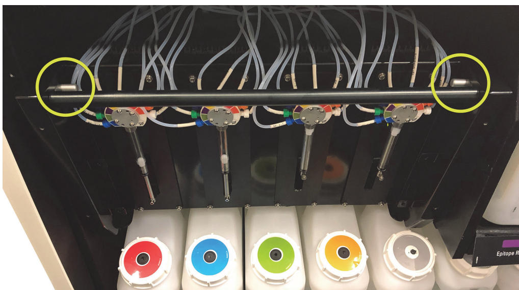
図 131: ユニットが開き、手が届く状態になったときのリリースピンの位置
