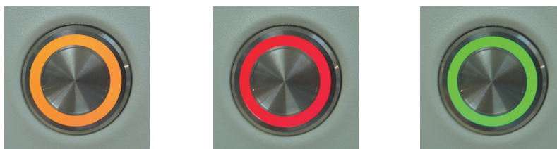
図 13: BOND-MAX 装置上のスライドトレイの LED の色（オレンジ、赤、緑）
