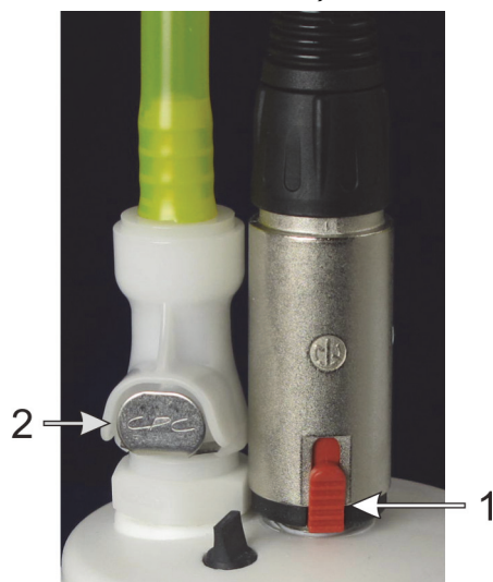
図 126: 外部廃液容器のコネクタ: 左は流路コネクタ、右は液体レベルセンサーコネクタ
