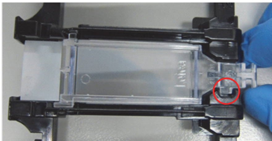
図 44: スライド上に Covertile を配置する
