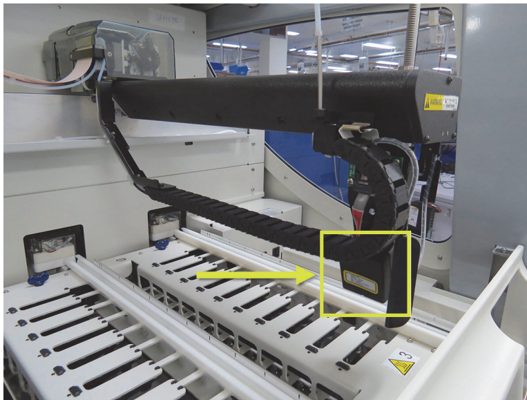
図 7: メインロボットと ID イメージャーの写真（矢印で示す）
