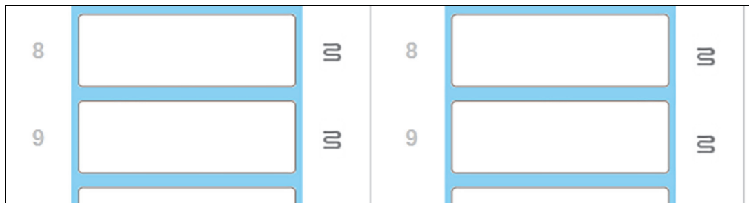
図 50: ヒーターの動作が停止すると、各位置のヒーターのシンボルが灰色になります。
