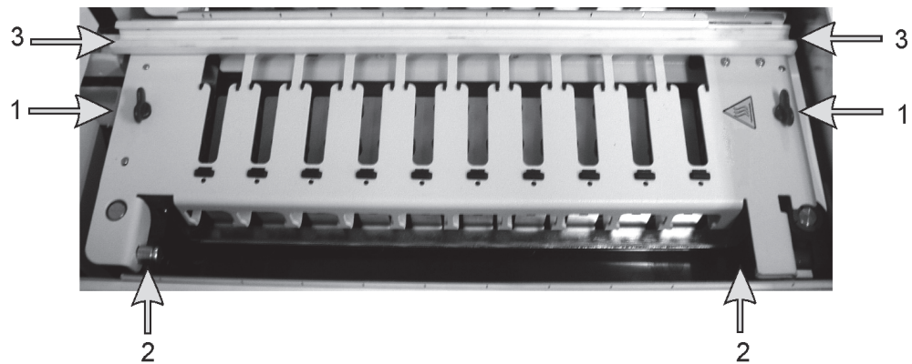
図 128: BOND-III 上部プレート (ツイストファスナー (1)、ピボットヒンジ (2) バルク溶液口ポットガイドレール (3))
