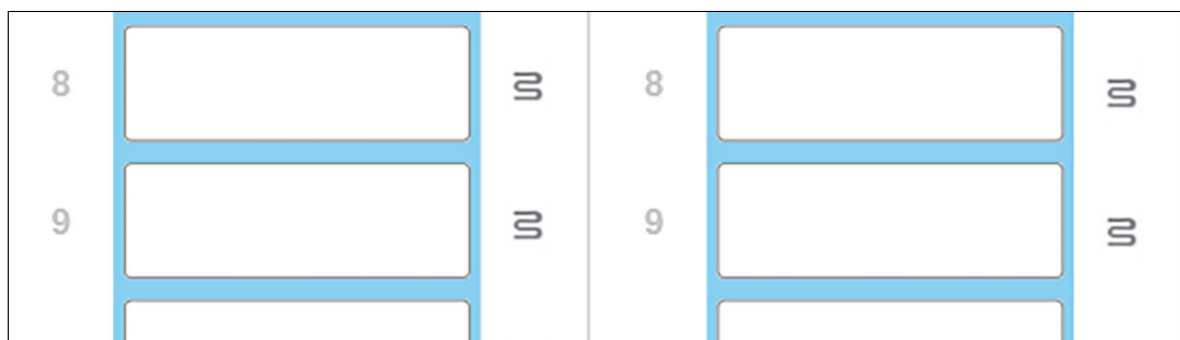
図 9: ヒーターの動作が停止すると、各位置のヒーターのシンボルが灰色になります。
