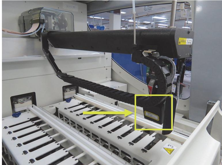
그림 7: ID 이미저(화살표로 표시)가 장착되어 있는 기본 로봇의 사진
