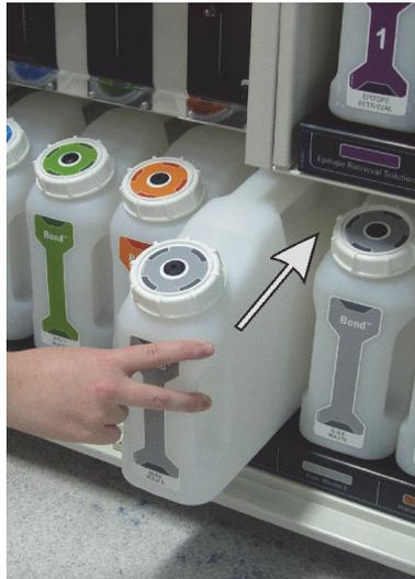
그림 123: 폐기물 컨테이너를 다시 제자리에 설치
