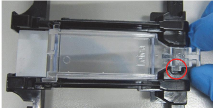
그림 44: **Covertile**을 슬라이드에 장착
