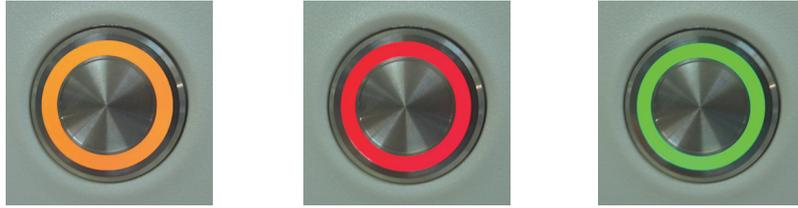
그림 13: BOND-MAX기기의 슬라이드 트레이 LED 색상(주황색, 빨간색, 녹색)
