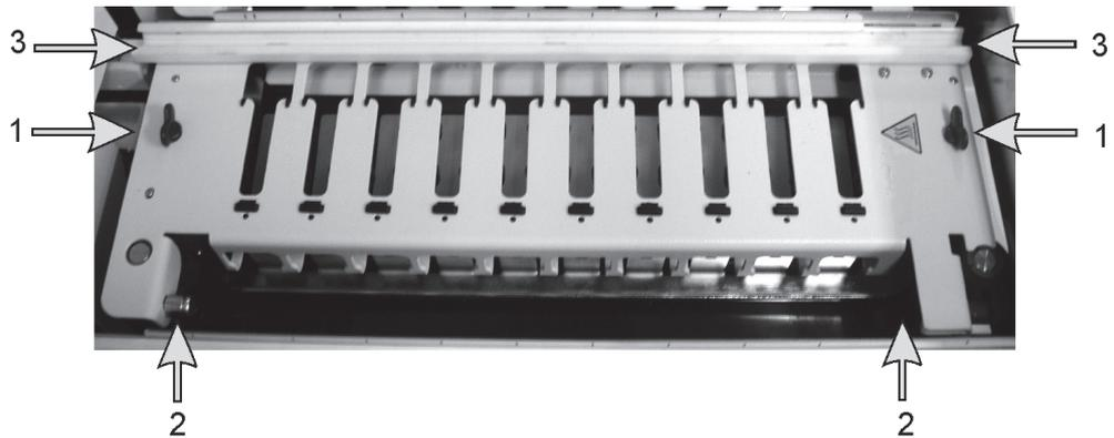
그림 128: BOND-III 상판 - 비틀림 잠쇠(1), 회전 경첩(2), 벌크 유체 로봇 가이드 레일(3)이 보임
