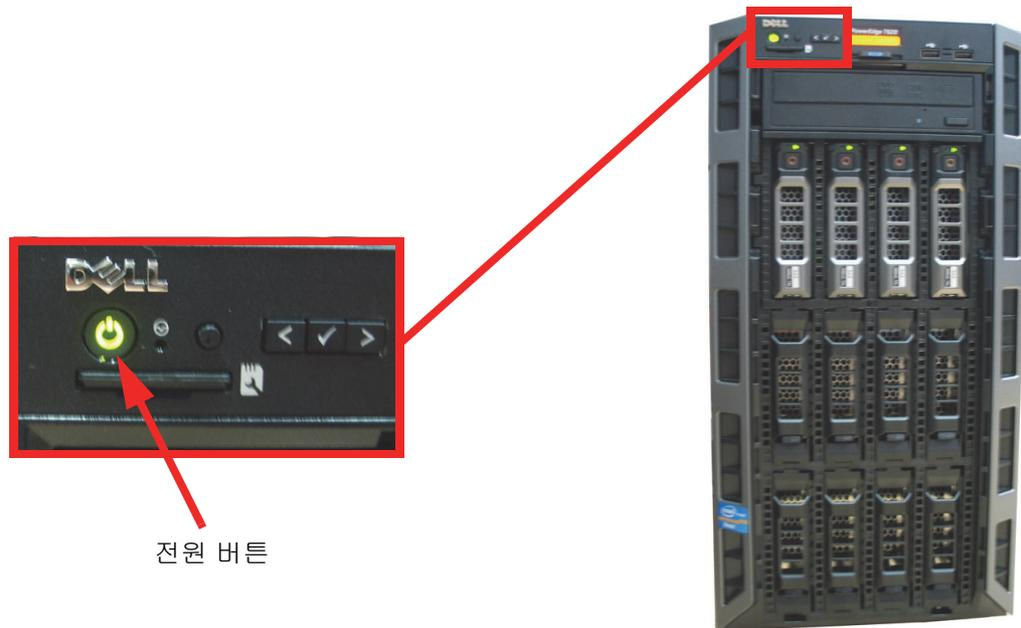
그림 150: 컨트롤러 정면 패널의 전원 버튼 위치(그림은 커버를 제거한 상태)
