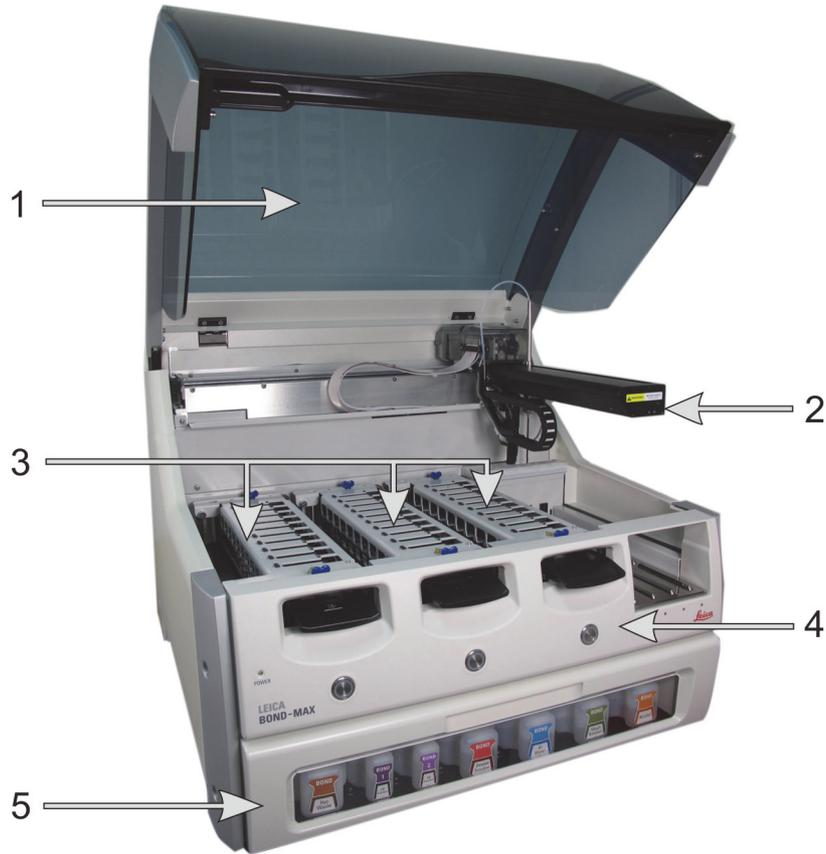
그림 4: BOND-MAX 처리 모듈의 정면도
