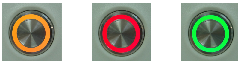
Figur 2-13: LED-farger for objektglassbrett (oransje, rødt, grønt) på BOND-MAX-instrumentet
