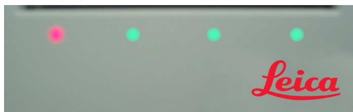
Figur 2-14: Reagensbrett LED-farger (rødt, grønt) på BOND-MAX-instrumentet
