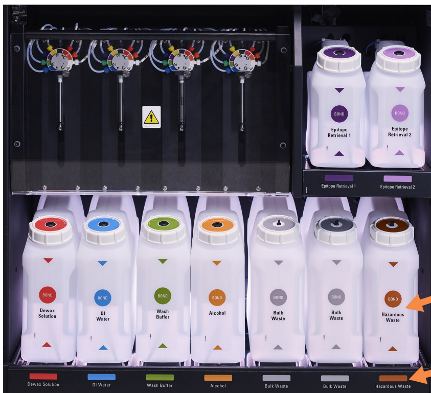
Postać 2-15: Zbiorcze pojemniki na odczynniki BOND-III we właściwym miejscu
