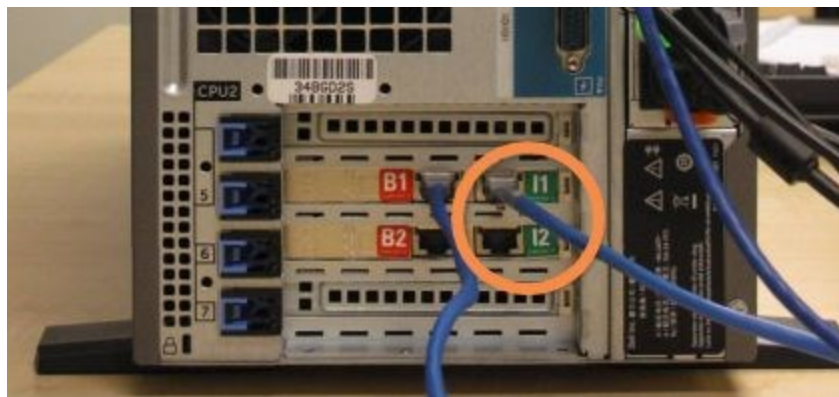
Figure 16-3: Porty urządzenia na kontrolerze
