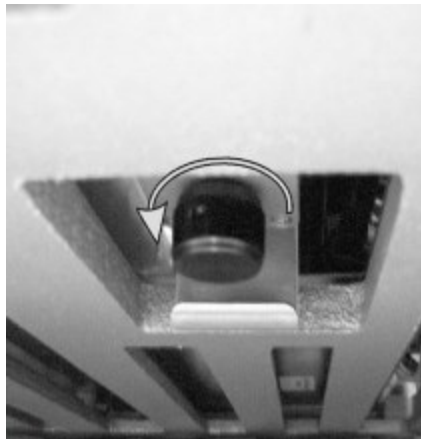
Figure 12-10: Ręczne pokrętło zwalniające
