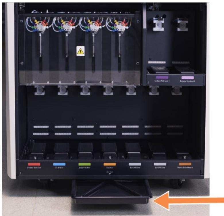
Postać 12-16: Taca ociekowa urządzenia BOND-III
