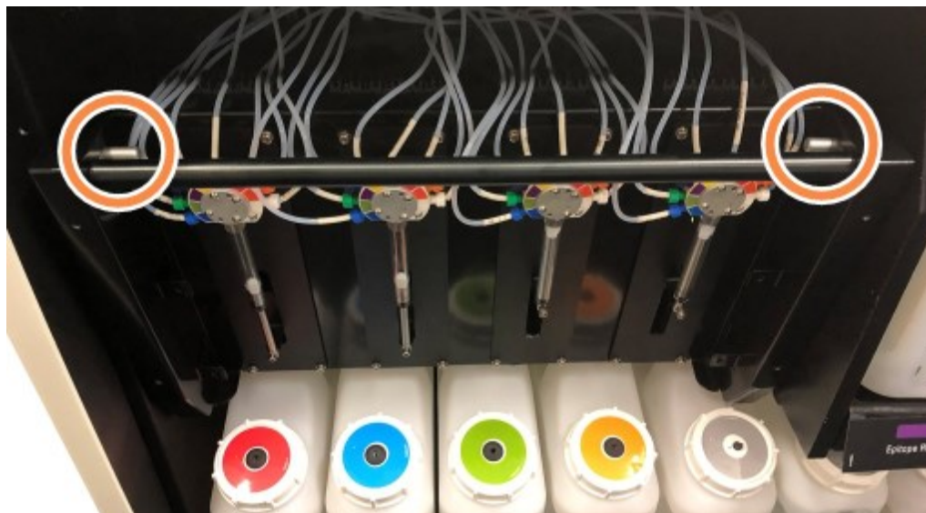
Figure 12-9: Położenie kołków zwalniających przy otwartej jednostce
