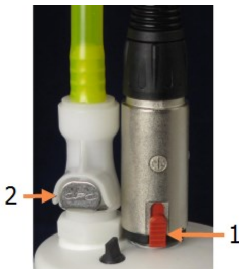
Figure 12-4: Złącza zewnętrznego pojemnika na odpady
