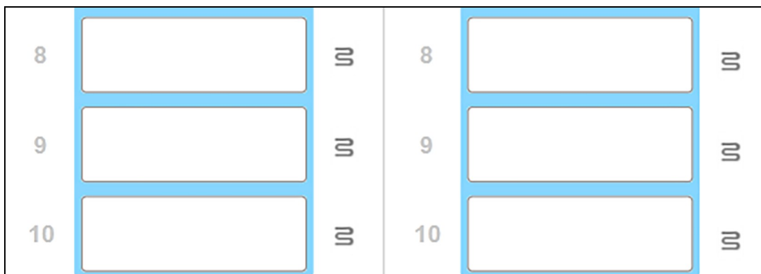
Postać 5-4: Szare symbole podgrzewaczy we wszystkich pozycjach oznaczają całkowite wyłączenie podgrzewania
