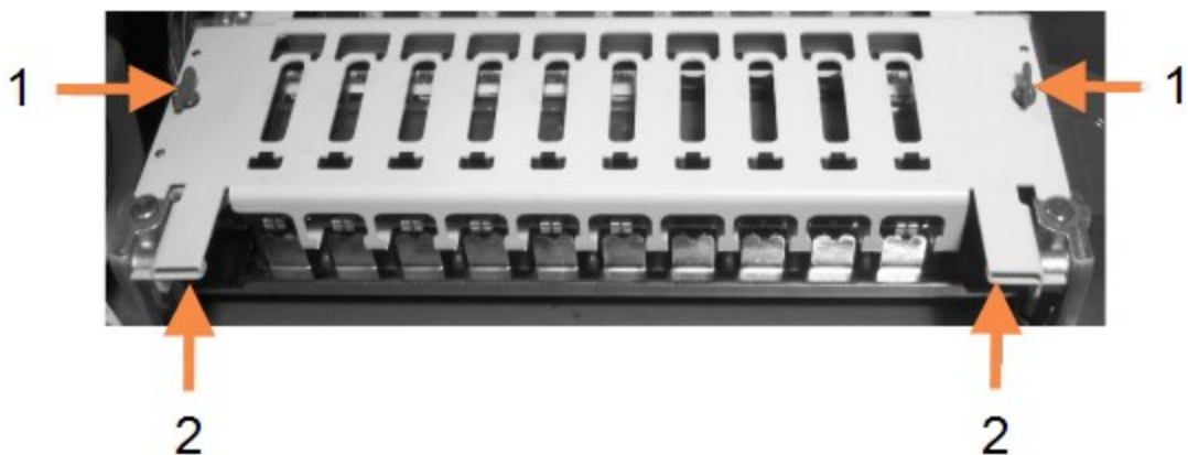
Figure 12-6: Płyta górna BOND-III
