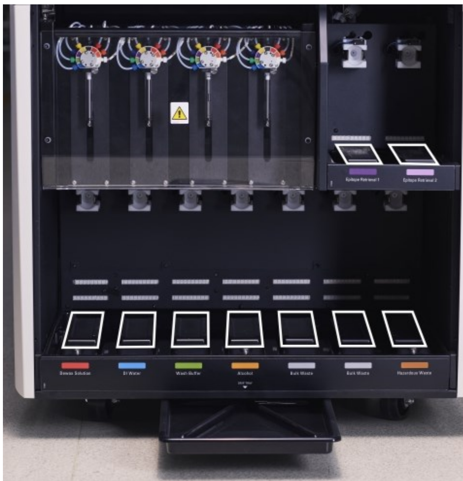
Figure 12-15: Tace ociekowe do pojemników zbiorczych BOND-III z widocznymi osłonami czujników masy
