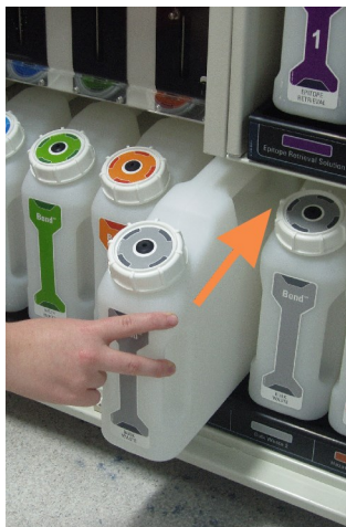
Postać 12-1: Umieszczanie pojemnika na odpady w odpowiedniej pozycji
