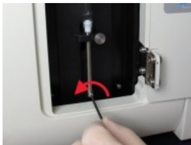
Figure 12-19: Odkręcanie śruby blokującej trzpień za pomocą klucza imbusowego
