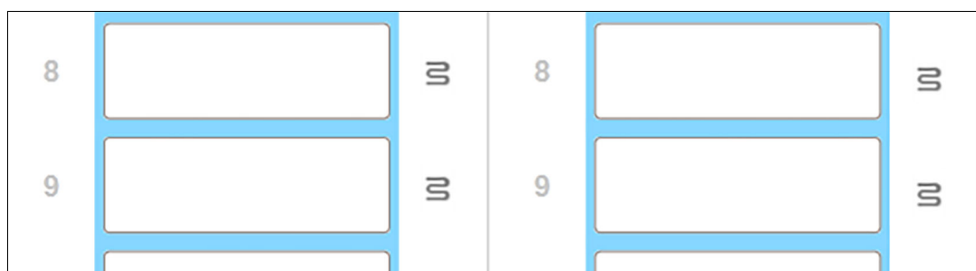
Рисунок 50: Серые значки нагревателей во всех положениях указывают на полное отключение нагрева
