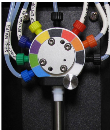
Рисунок 24: Шприц BOND-MAX с 9 разъемами
