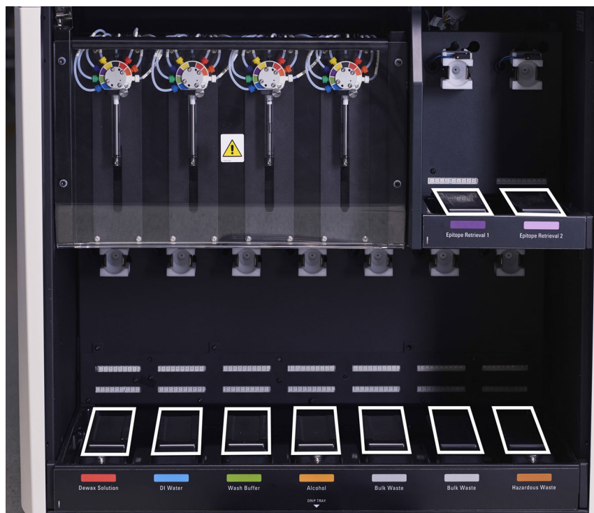
Рисунок 137: Поддоны для больших контейнеров BOND-III с показанными крышками датчиков веса
