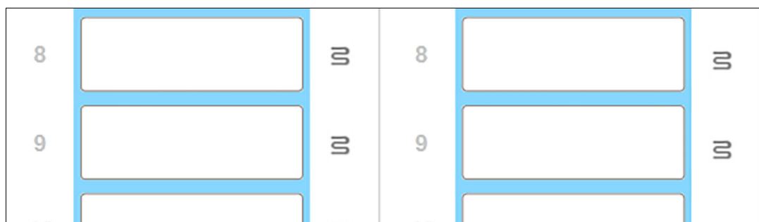
Рисунок 9: Серые значки нагревателей во всех положениях указывают на полное отключение нагрева
