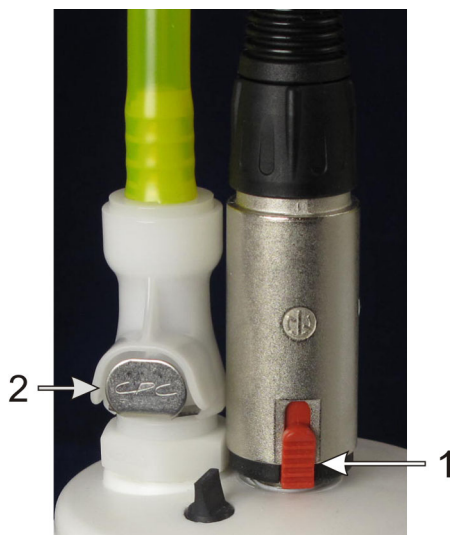
Рисунок 126: Соединения внешнего контейнера для отходов: соединитель линий жидкостей слева, соединитель датчика уровня жидкости справа
