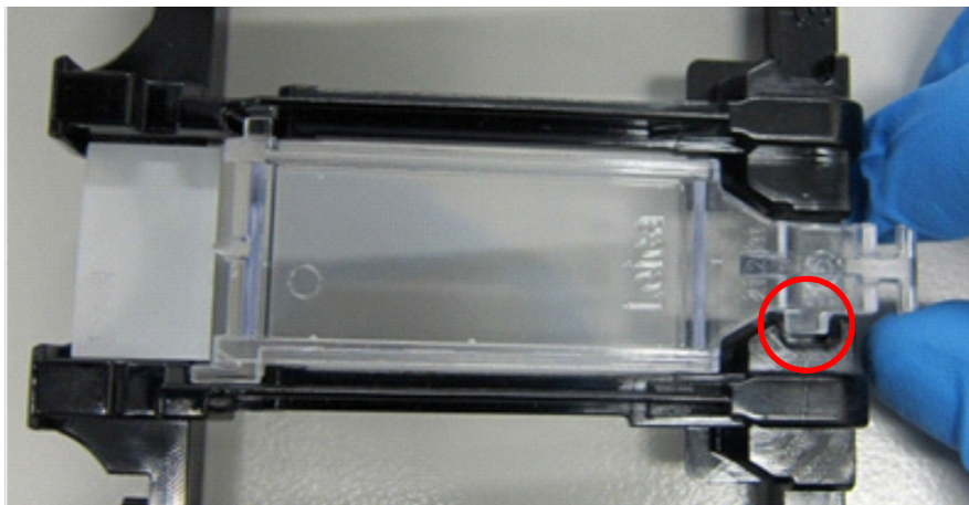
Рисунок 44: Установка крышечки Covertile на препарат
