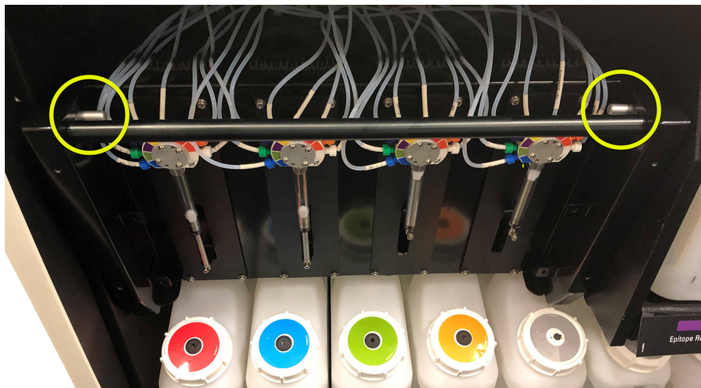
Рисунок 131: Расположение штырьков разблокировки в открытом для доступа модуле
