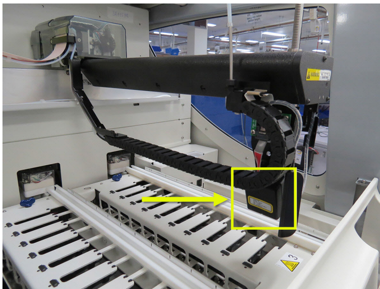
Рисунок 7: Фотография основного робота с показанным стрелкой считывателем идентификаторов
