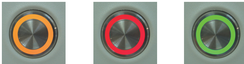
Figura 13: Colores de los LED de la bandeja de portaobjetos (naranja, rojo, verde) en el instrumento BOND-MAX
