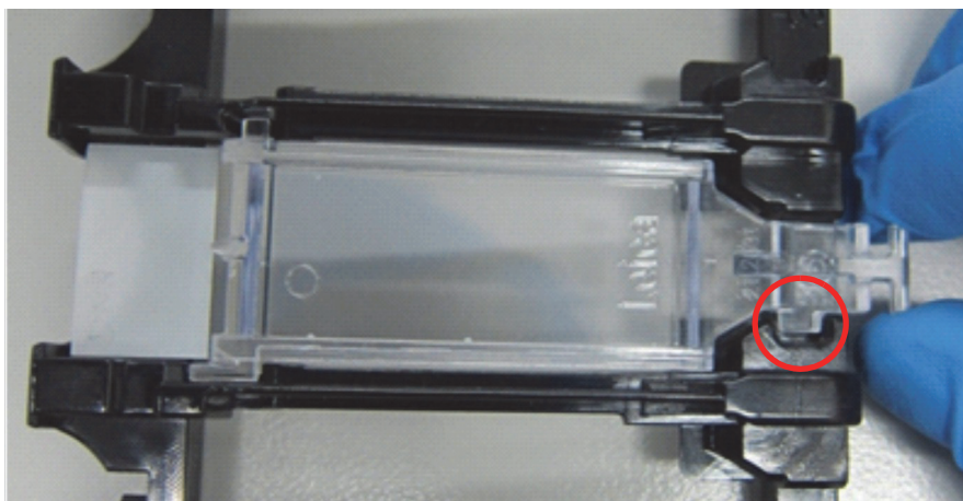
Figura 44: Colocación de un Covertile en un portaobjetos
