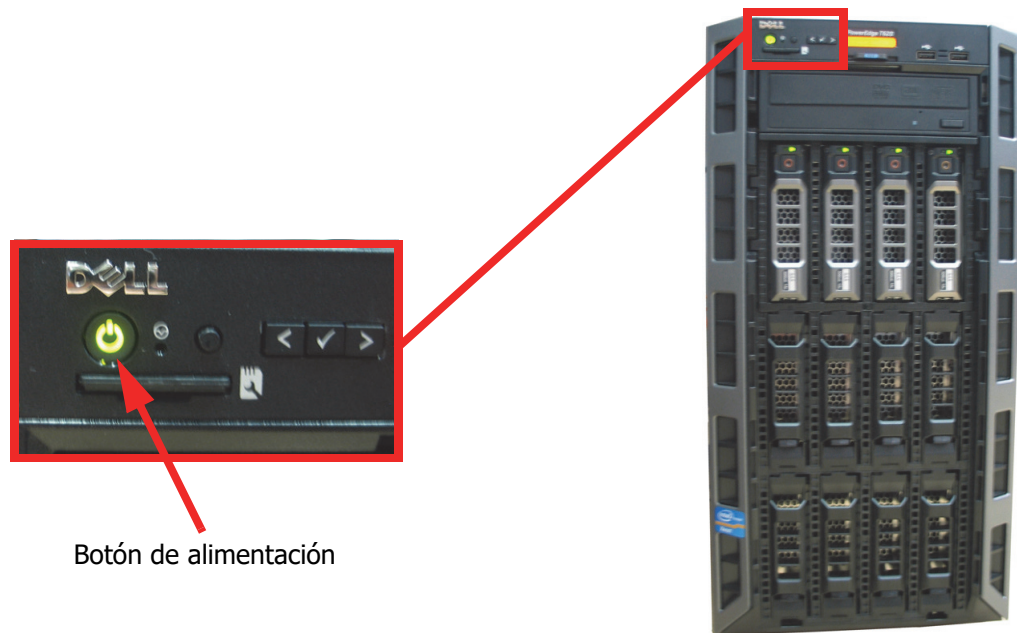
Figura 150: Ubicación del botón de alimentación en el panel frontal del controlador (se muestra con la cubierta retirada)
