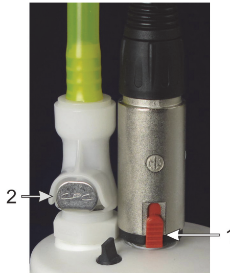
Figura 126: Conexiones de recipiente de residuos externo: conector de fluido a la izquierda y conector de sensor del nivel de líquido a la derecha
