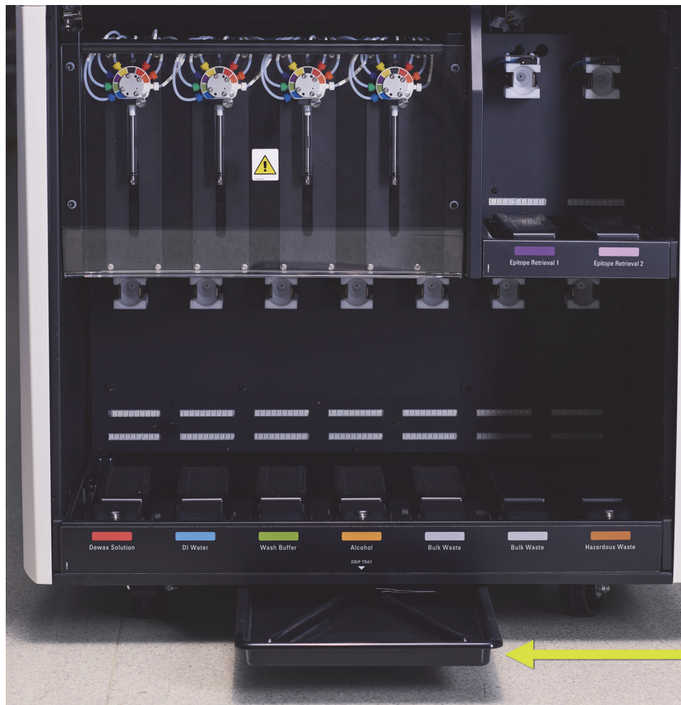
Figura 138: la bandeja de goteo del instrumento BOND-III
