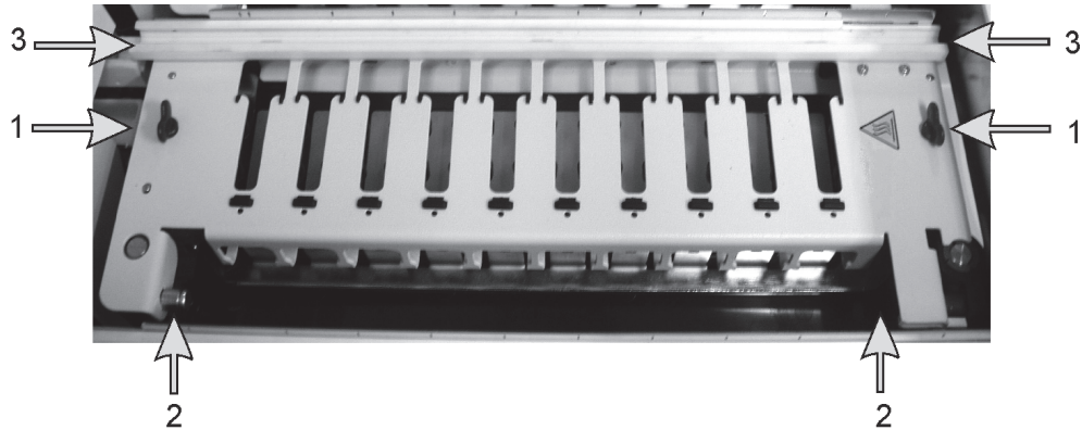
Figura 128: Placa superior de BOND-III mostrando las palomillas (1), las bisagras de pivote (2) y el rail de guía del robot de distribución de fluidos (3)
