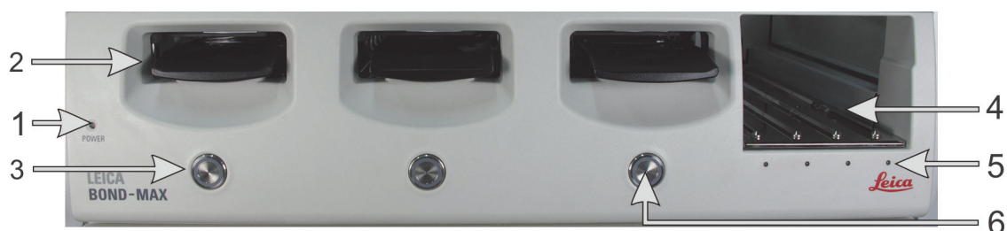
Figura 11: Cubierta frontal de BOND-MAX
