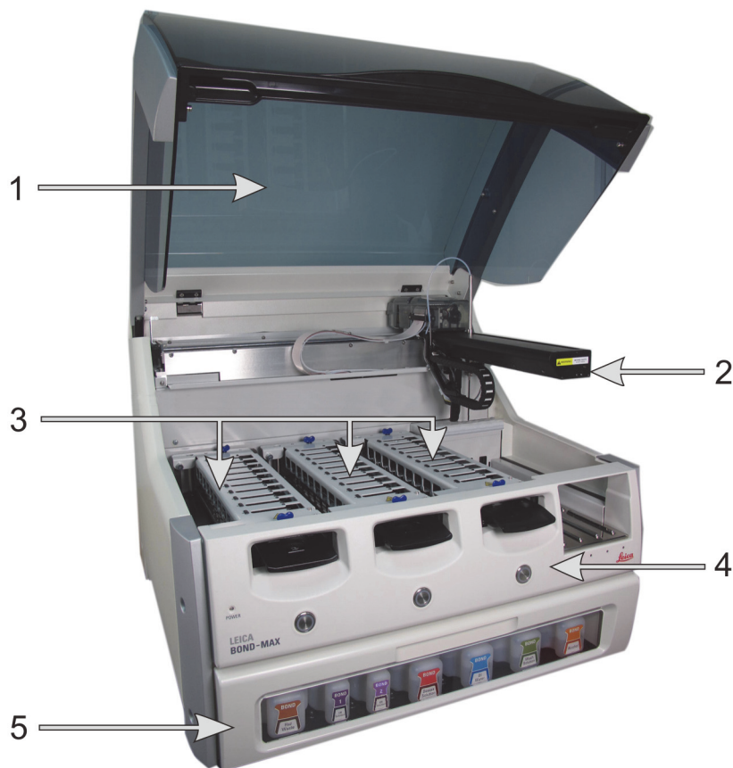
Figura 4: Vista frontal del módulo de procesamiento BOND-MAX
