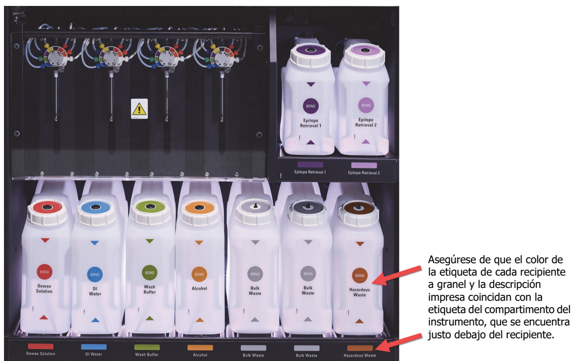
Figura 15: Recipientes de reactivos a granel BOND-III en posición
