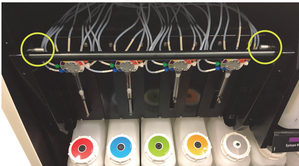
Figura 131: ubicación de los pasadores de liberación con la unidad abierta para el acceso
