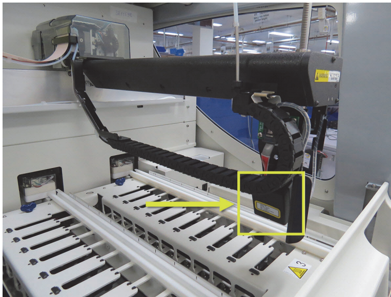
Figura 7: fotografía del robot principal con la flecha indicando la posición del lector de ID
