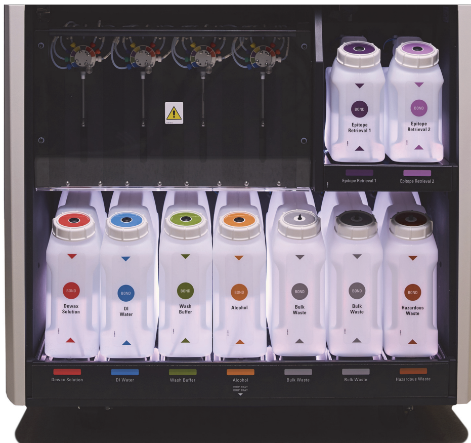
Figura 16: Sistema de iluminación del recipiente a granel
