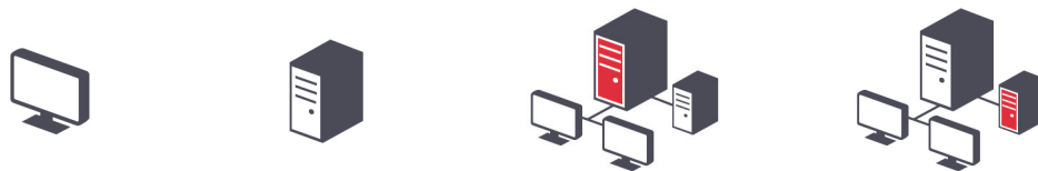
Figur 35: Ikonerna för en terminal, en ensam kontrollenhet, en primär kontrollenhet och en sekundär kontrollenhet
