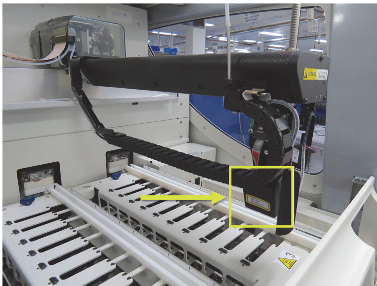
Figur 7: Foto av huvudroboten med ID-avbildaren markerad med pilen
