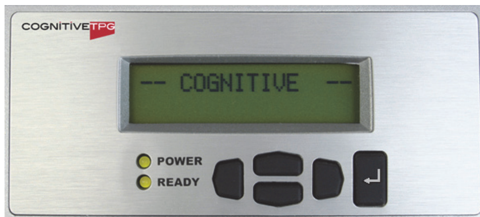
Figur 157: Cognitive skrivarens LCD-display och knappsats
