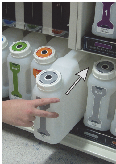
Figur 123: Sätt tillbaka avfallsbehållaren på dess plats
