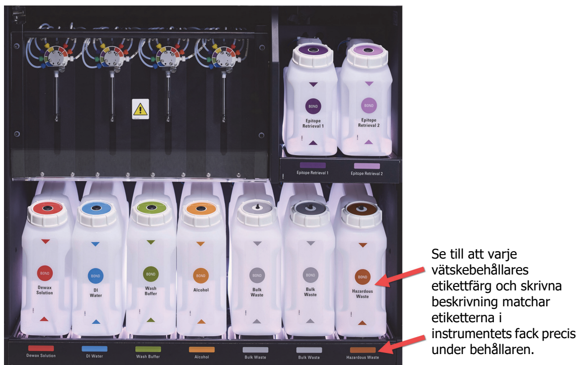
Figur 15: BOND-III-standardreagensbehållare på plats
