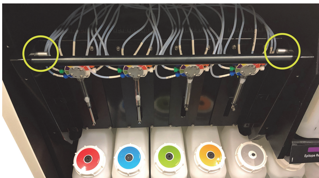
Figur 131: Placering av frigöringspinnarna med enheten öppen för åtkomst
