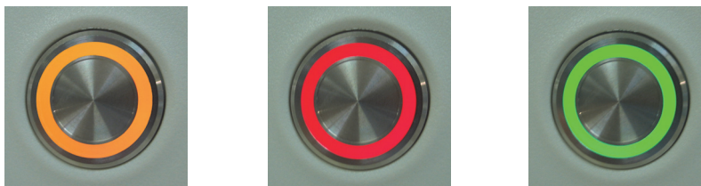
Figur 13: Preparatbrickans LED-färger (orange, röd, grön) på BOND-MAX-instrumentet
