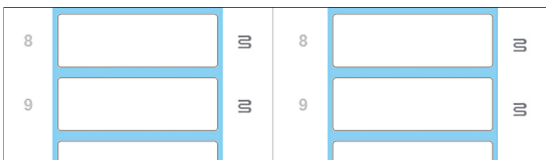
Figur 9: Grå värmarsymboler för varje position anger att hela uppvärmningssystemet är avstängt
