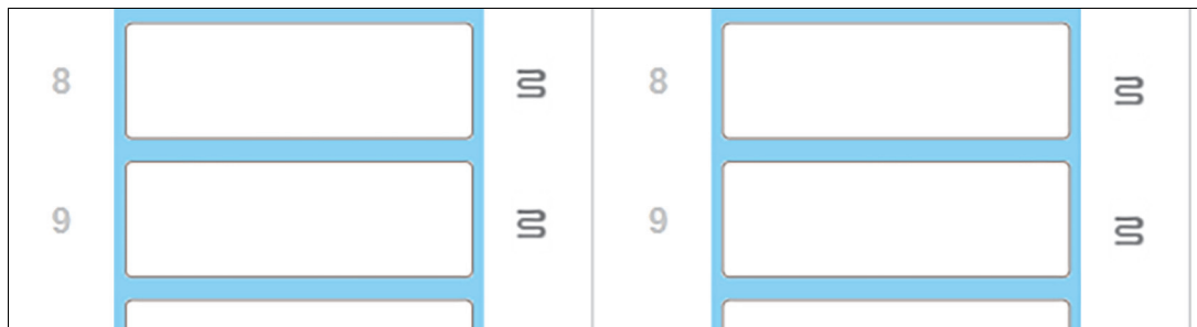
Figur 50: Grå värmarsymboler för varje position anger att hela uppvärmningssystemet är avstängt
