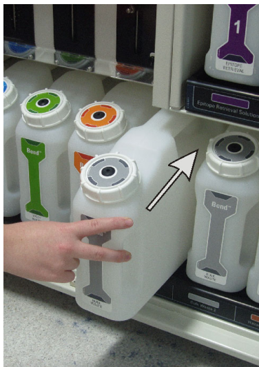
Figura 123: Para recolocar o tanque de descarte em sua posição
