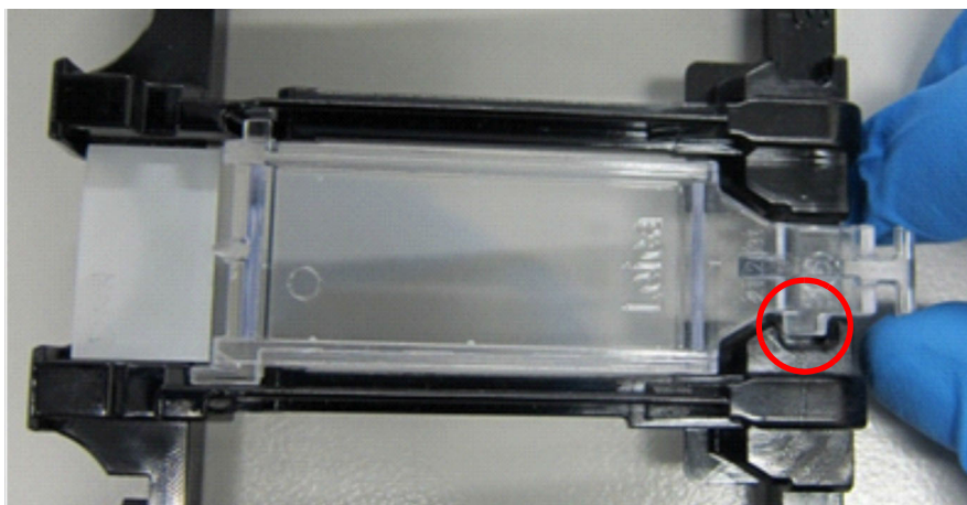
Figura 44: Para posicionar um Covertile sobre uma lâmina
