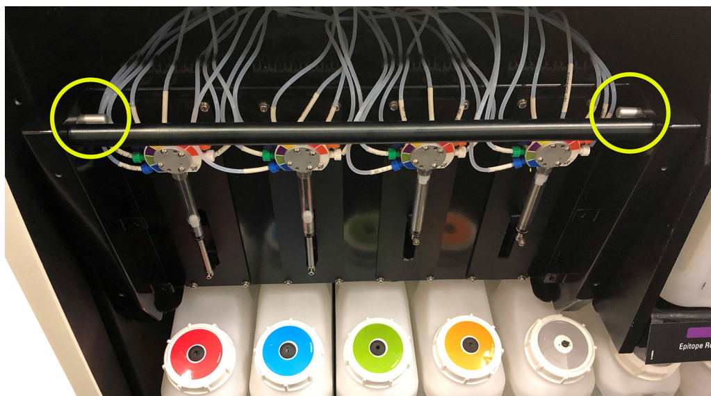
Figura 131: Localizar os pinos de liberação com a unidade aberta para acesso
