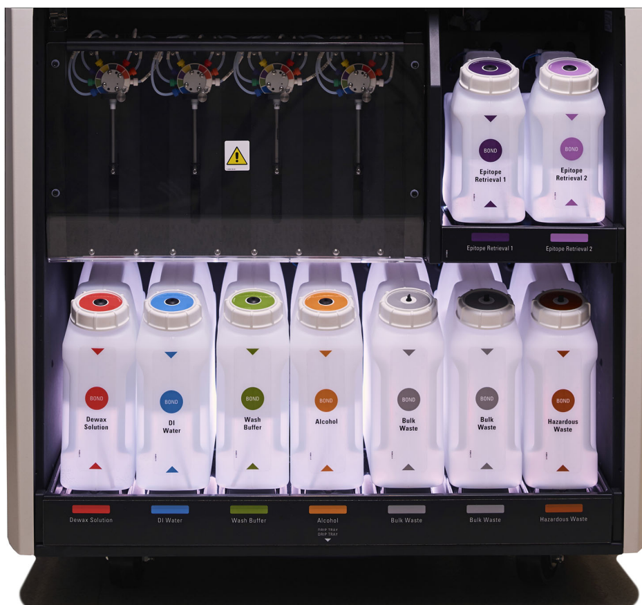
Figura 16: Sistema de iluminação do tanque de solução
