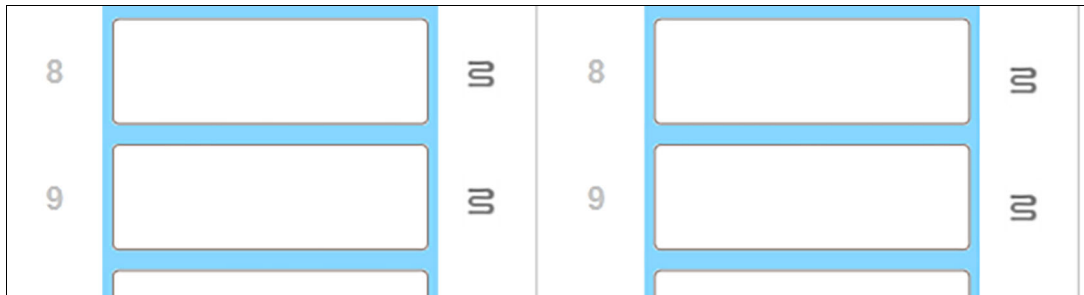
Figura 50: Símbolos cinza do bloco de aquecimento em cada posição indicam um completo desligamento do aquecimento
