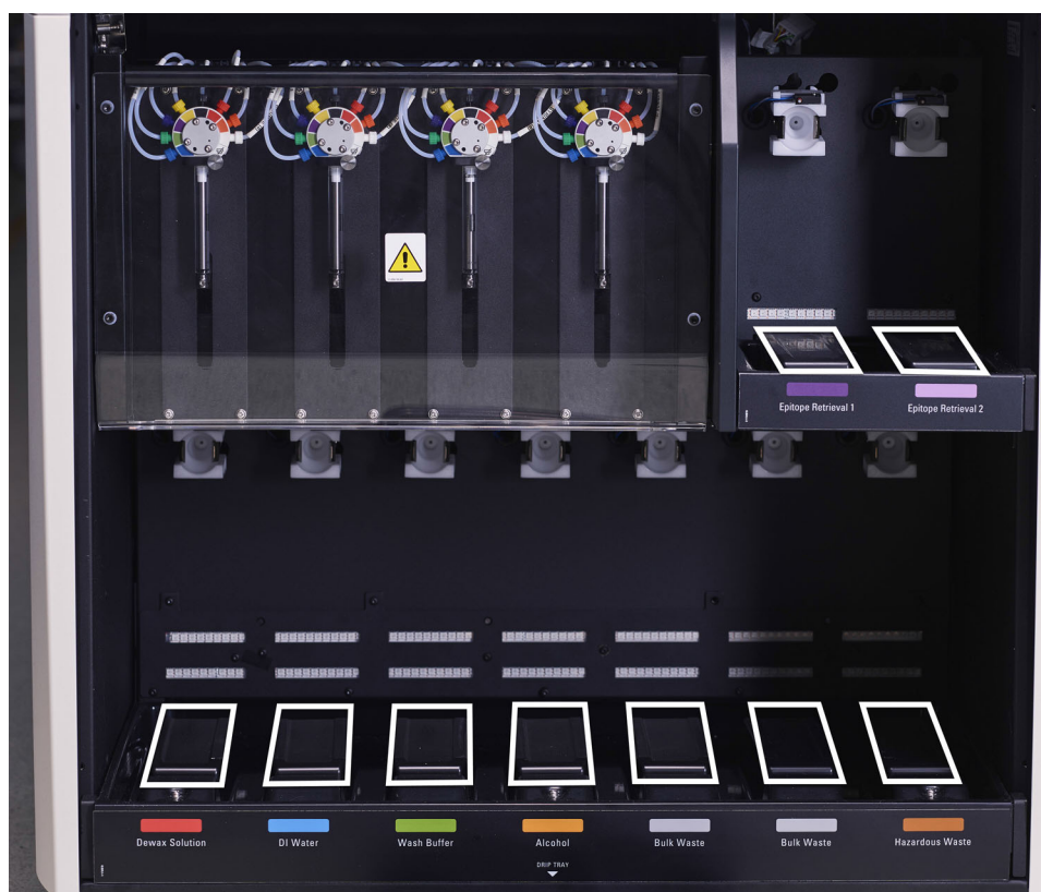
Figura 137: BOND-III bandejas de proteção mostrando as coberturas dos sensores de peso
