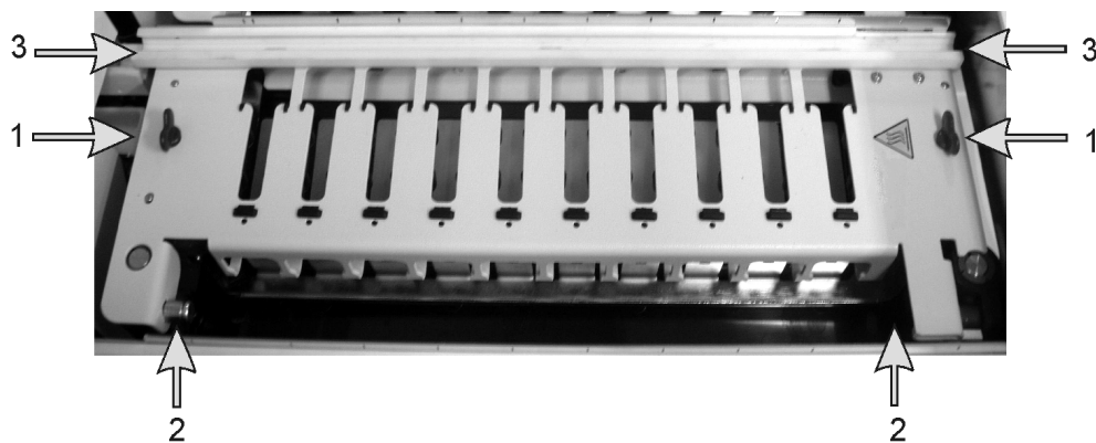
Figura 128: BOND-III chapa superior exibindo as presilhas (1), dobradiças giratórias (2) e o guia do trilho do robô auxiliar (3)
