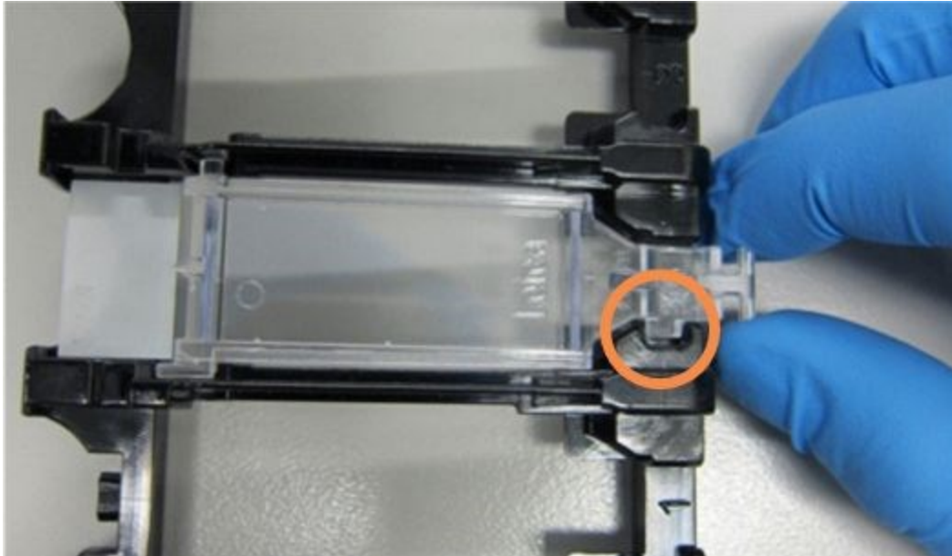
Figură 4-6: Poziționarea unui element Covertile pe o lamă
