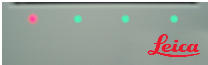
Figură 2-14: Culoarele indicatorului LED pentru tava pentru reactivi (roșu, verde) pe instrumentul BOND-MAX
