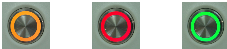
Figură 2-13: Culorile indicatoarelor LED pentru tava pentru lame (portocaliu, roșu, verde) pe instrumentul BOND-MAX
