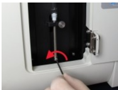
Figură 12-23: Deșurubarea șurubului de blocare a pistonului cu o cheie hexagonală
