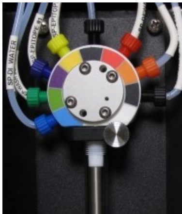
Figură 2-24: Seringă BOND-MAX cu 9 porturi
