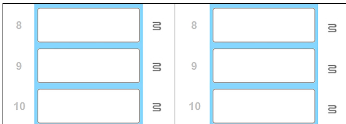
Figură 5-4: Simbolurile de încălzire gri din fiecare poziție indică o închidere completă a încălzirii
