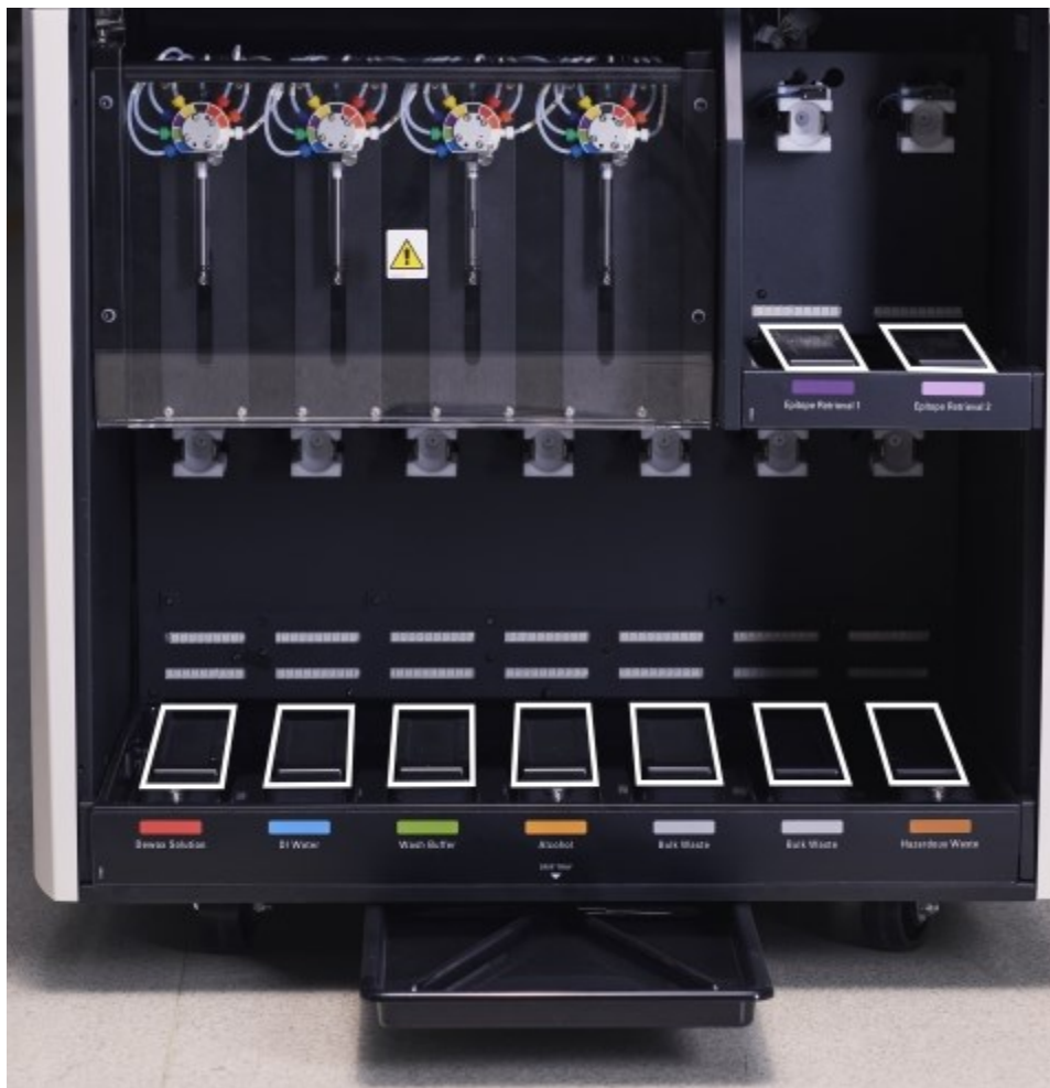
Фигура 12-15: Табли за отцеждане за наливни резервоари BOND-III и капаци на сензора за тегло
