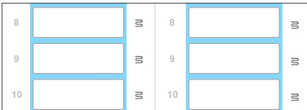
Фигура 2-9: Сивите символи на нагревател на всяка позиция показват пълно изключване на нагревателите
