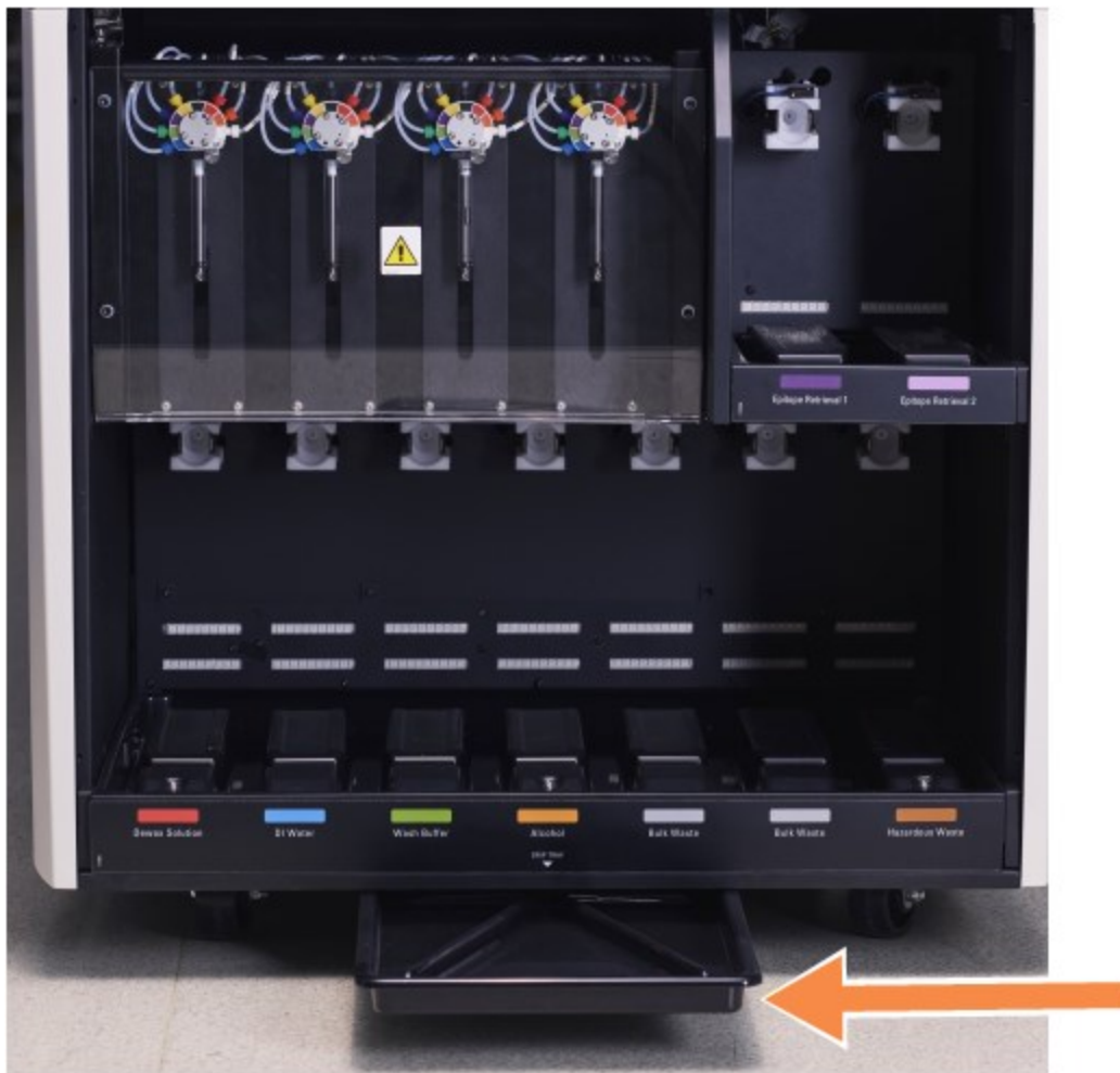
Фигура 12-16: Таблата за отцеждане за инструмент BOND-III
