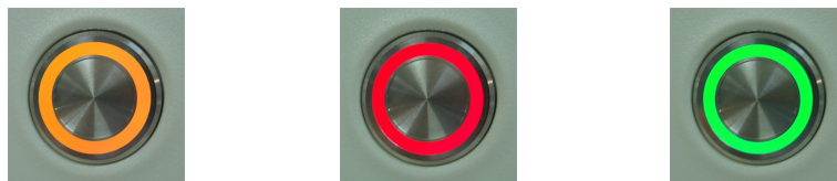
Фигура 2-13: Цветове на светодиода за таблата за предметни стъкла (оранжев, червен, зелен) на инструмент BOND-MAX
