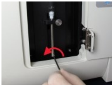
Фигура 12-19: Развиване на винта за заключване на буталото с шестограм
