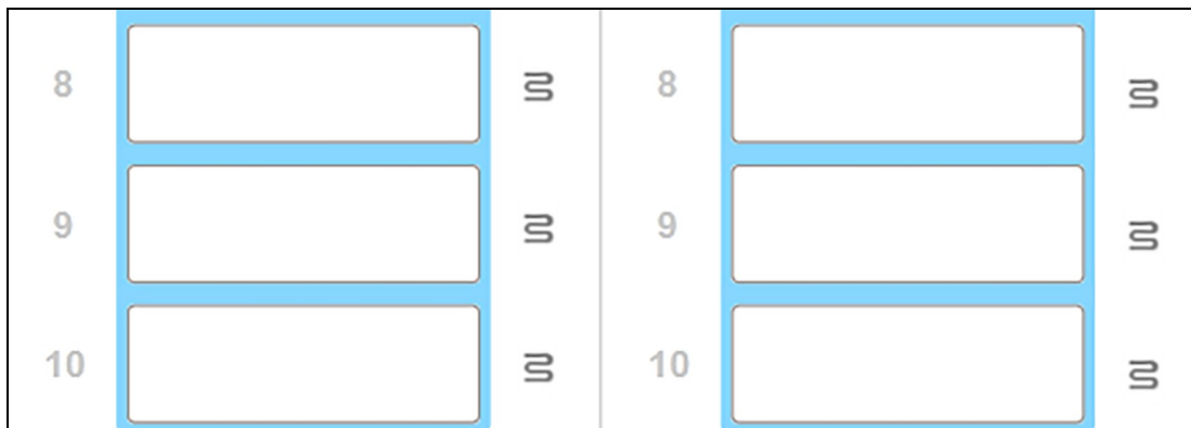
Фигура 5-4: Сивите символи на нагревател на всяка позиция показват пълно изключване на нагревателите
