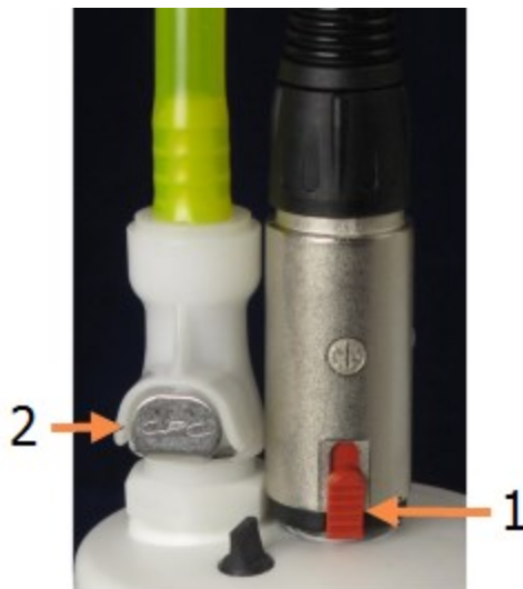
Фигура 12-4: Връзки на външния резервоар за отпадъци
