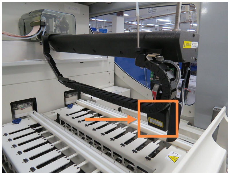
Obrázok 2-7: Fotografia hlavného robota so snímačom identifikátorov označeným šípkou
