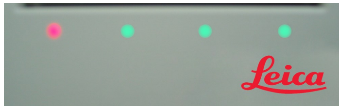
Obrázok 2-14: Farby kontrolky LED podnosu na reagenty (červená, zelená) na prístroji BOND-MAX
