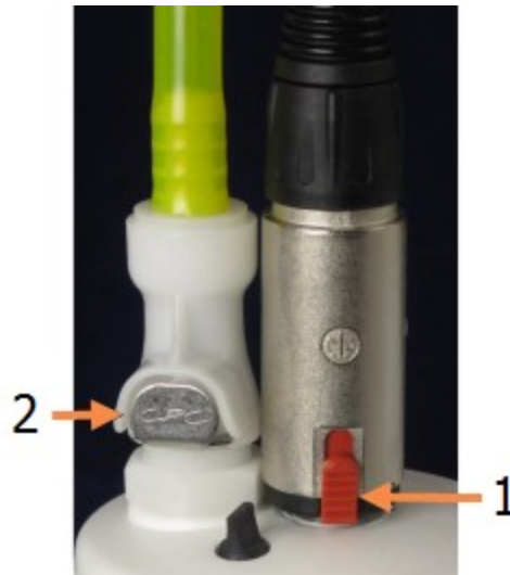
Obrázok 12-4: Pripojenie nádoby na externý odpad
