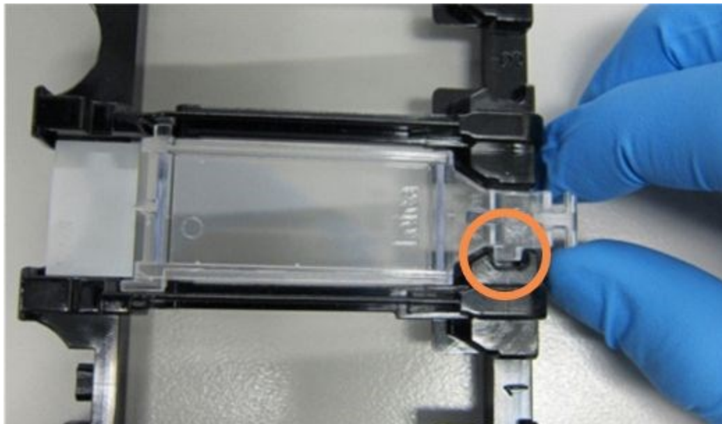
Obrázok 4-6: Umiestnenie krycieho sklíčka Covertile na podložné sklíčko
