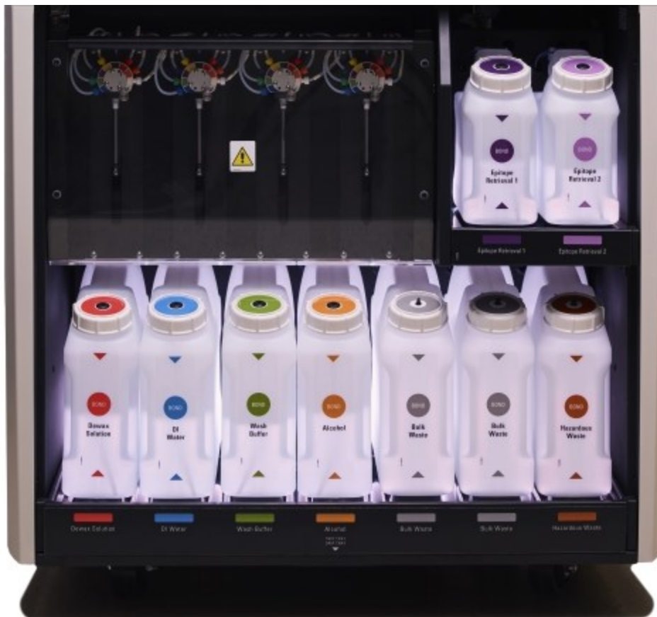
Obrázok 2-16: System osvetlenia nádob na nebalený materiál
