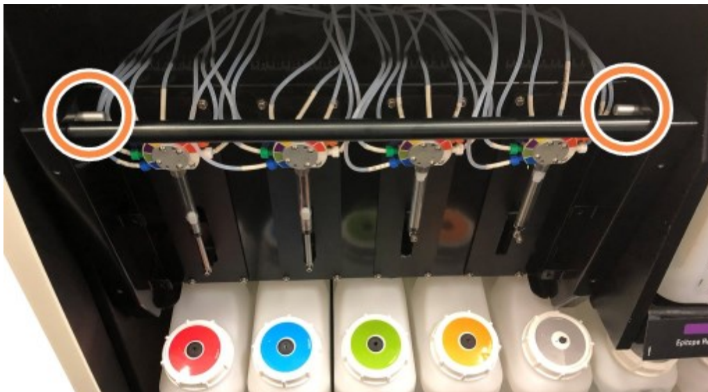
Obrázok 12-9: Umiestnenie uvoľňovacích kolíkov s otvorenou jednotkou pre prístup
