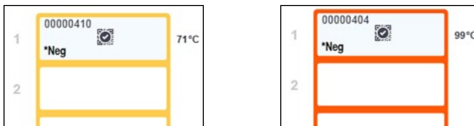
Obrázok 5-6: Hranice indikácie teploty podnosov na sklíčka: teplé (vľavo) a horúce (vpravo)
