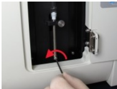
Obrázok 12-19: Odskrutkujte skrutku piesta pomocou kľúča s vnútorným šesťhranom.
