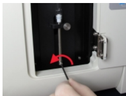
Малюнок 12-19: Відкручування стопорного гвинта поршня шестигранним ключем
