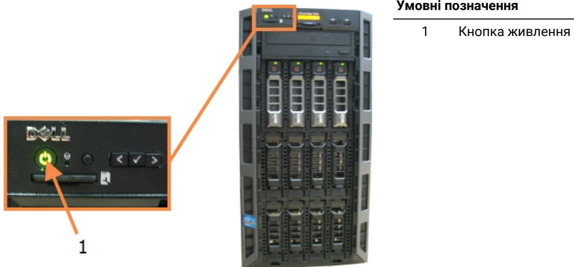
Малюнок 16-1: Розташування кнопки живлення на передній панелі контролера (показаний зі знятим кожухом)
