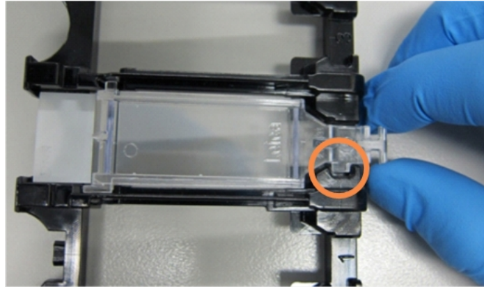
Малюнок 4-6: Встановлення кришечки Covertile на препарат
