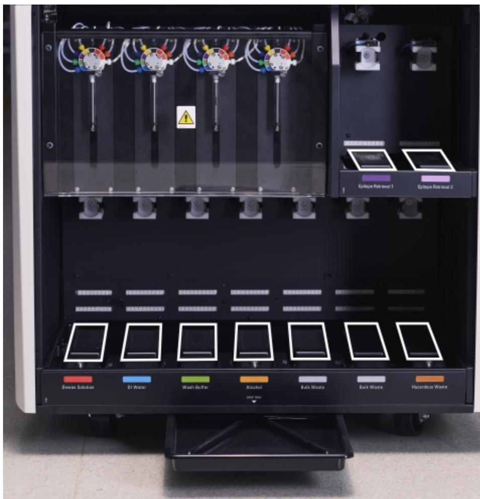
Малюнок 12-15: Піддони для великих контейнерів BOND-III з показаними кришками датчиків ваги
