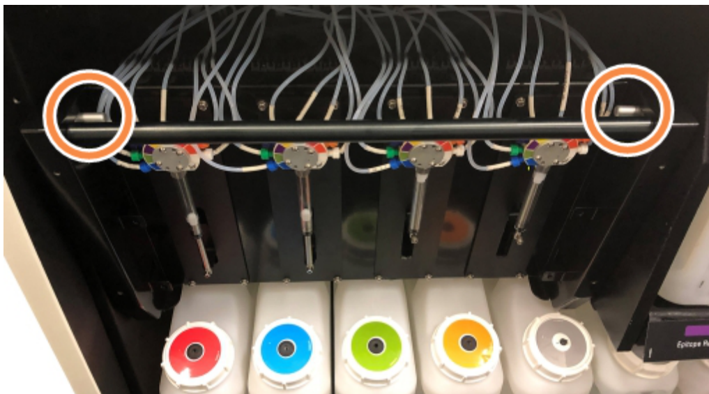
Малюнок 12-9: Розташування штирів розблокування у відкритому для доступу модулі
