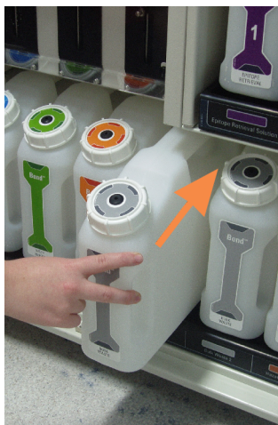
Малюнок 12-1: Повернення контейнера для відходів на своє місце
