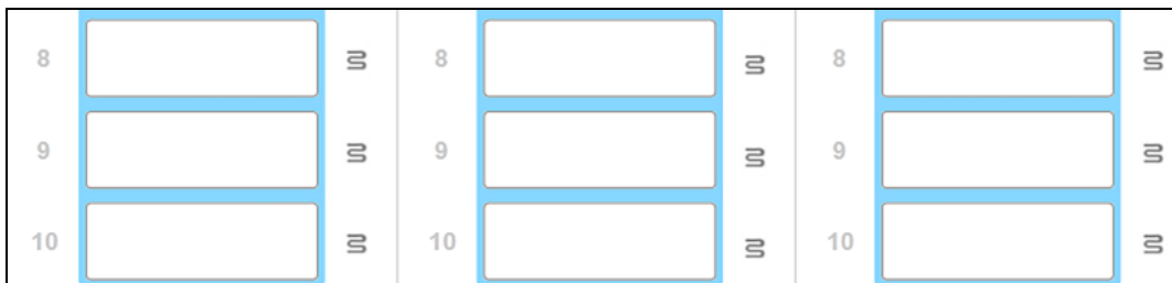
Малюнок 2-9: Сірі значки нагрівачів у всіх положеннях вказують на повне відключення нагріву
