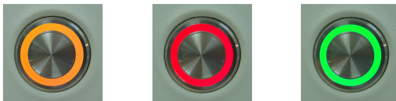
Slika 2–13: LED boje posudice za stakalce (narančasta, crvena, zelena) na BOND-MAX instrumentu
