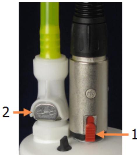
Slika 12-4: Priklučci za vanjski spremnik za otpadni materijal
