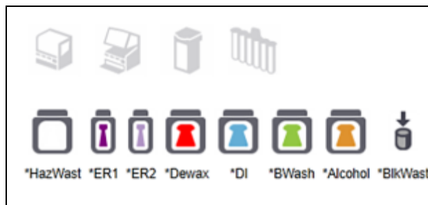
Slika 5–10: Spremnici za rasuti teret (BOND-MAX konfiguracija). Krajnja desna ikona predstavlja vanjski spremnik za otpadni materijal
