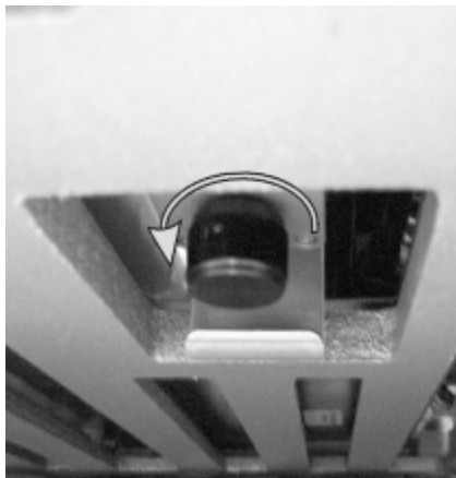
Slika 12–10: Gumb za ručno otpuštanje
