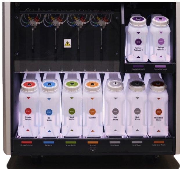
Slika 2-16: Rasvjetni sustav spremnika za rasuti teret
