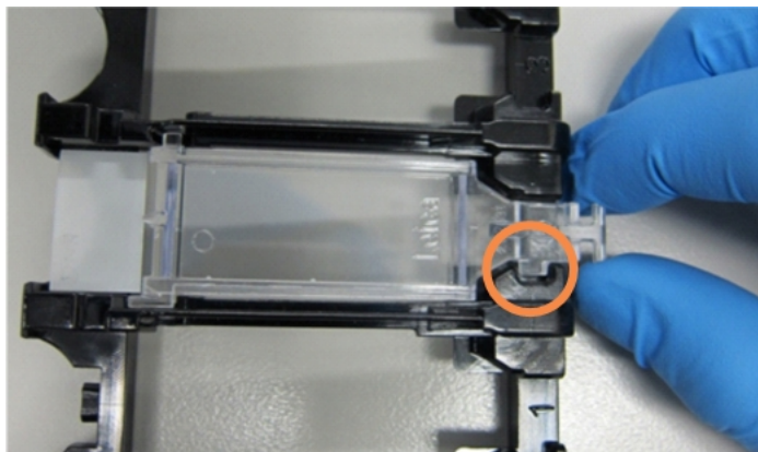
Slika 4-6: Postavljanje navlake na stakalce
