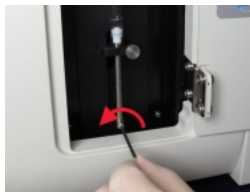
Slika 12–19: Imbus ključem odvrnite vijak za blokiranje klipa
