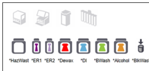
pav. 5–10: Baziniai indai (BOND-MAX konfigūracija). Dešiniausioji piktograma rodo išorinį atliekų indą
