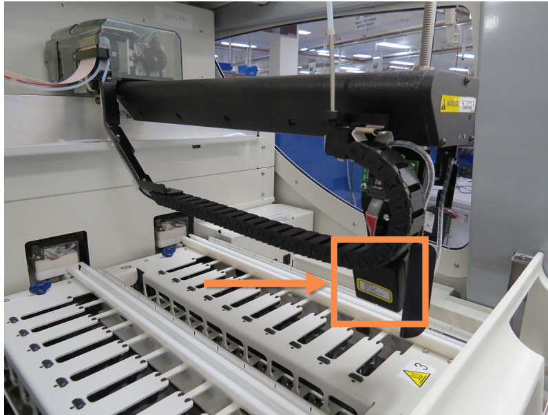
pav. 2–7: Pagrindinio roboto nuotrauka, kurioje ID skaitytuvas pažymėtas rodykle
