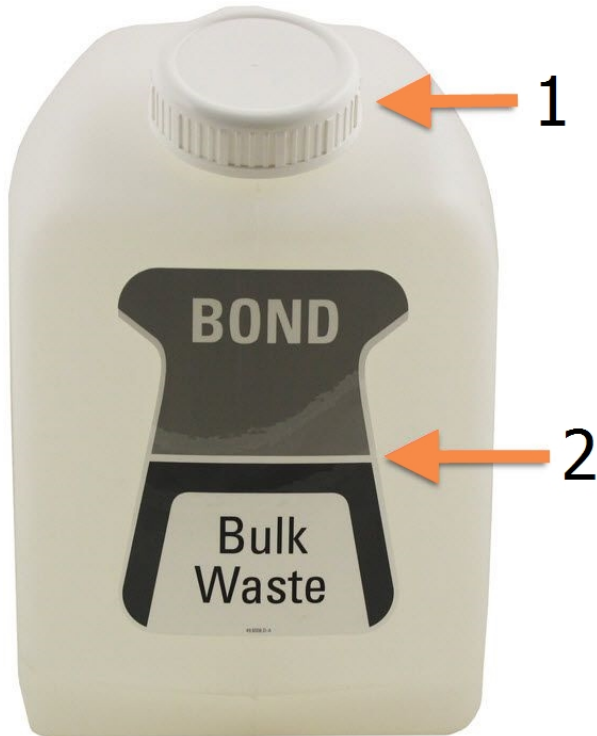
pav. 12–3: BOND-MAX 9 l išorinis standartinis atliekų laikymo indas
