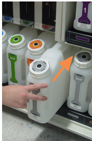
pav. 12–1: Atliekų laikymo indo grąžinimas į vietą
