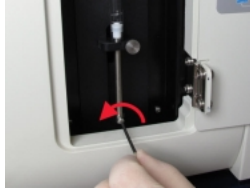
pav. 12–19: Stūmoklio fiksavimo varžto atsukimas šešiabriauniu raktu
