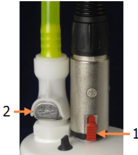
pav. 12–4: Išorinių atliekų laikymo indų jungtys
