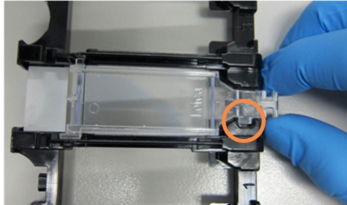
pav. 4–6: „Covertile“ uždėjimas ant objektinio stiklelio
