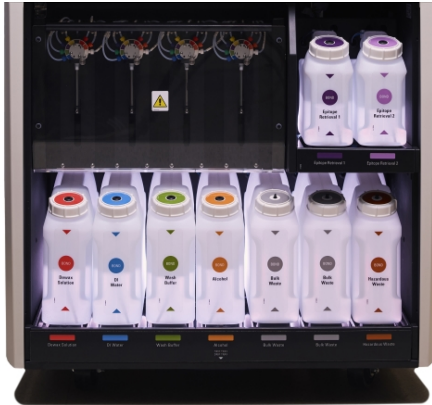
Εικόνα 2-15: Σύστημα φωτισμού μεγάλων δοχείων
