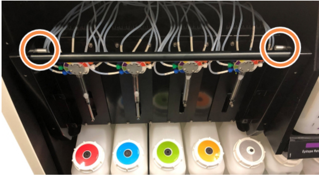
Εικόνα 12-9: Εντοπισμός των πύρων απελευθέρωσης με τη μονάδα ανοικτή για πρόσβαση
