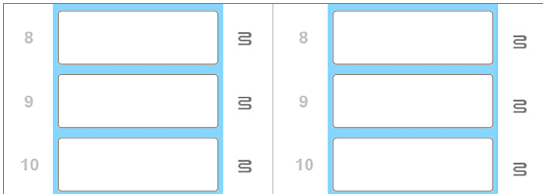
Figura 5-4: Símbolos cinza do bloco de aquecimento em cada posição indicam um completo desligamento do aquecimento
