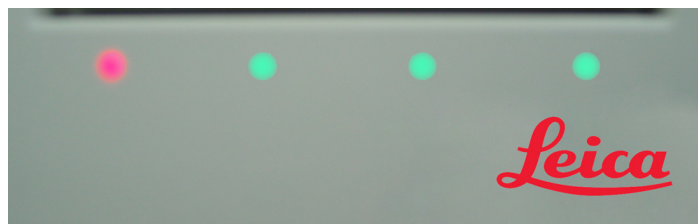
Figura 2-13: Cores do LED da bandeja de reagente (vermelho e verde) do instrumento do BOND-MAX
