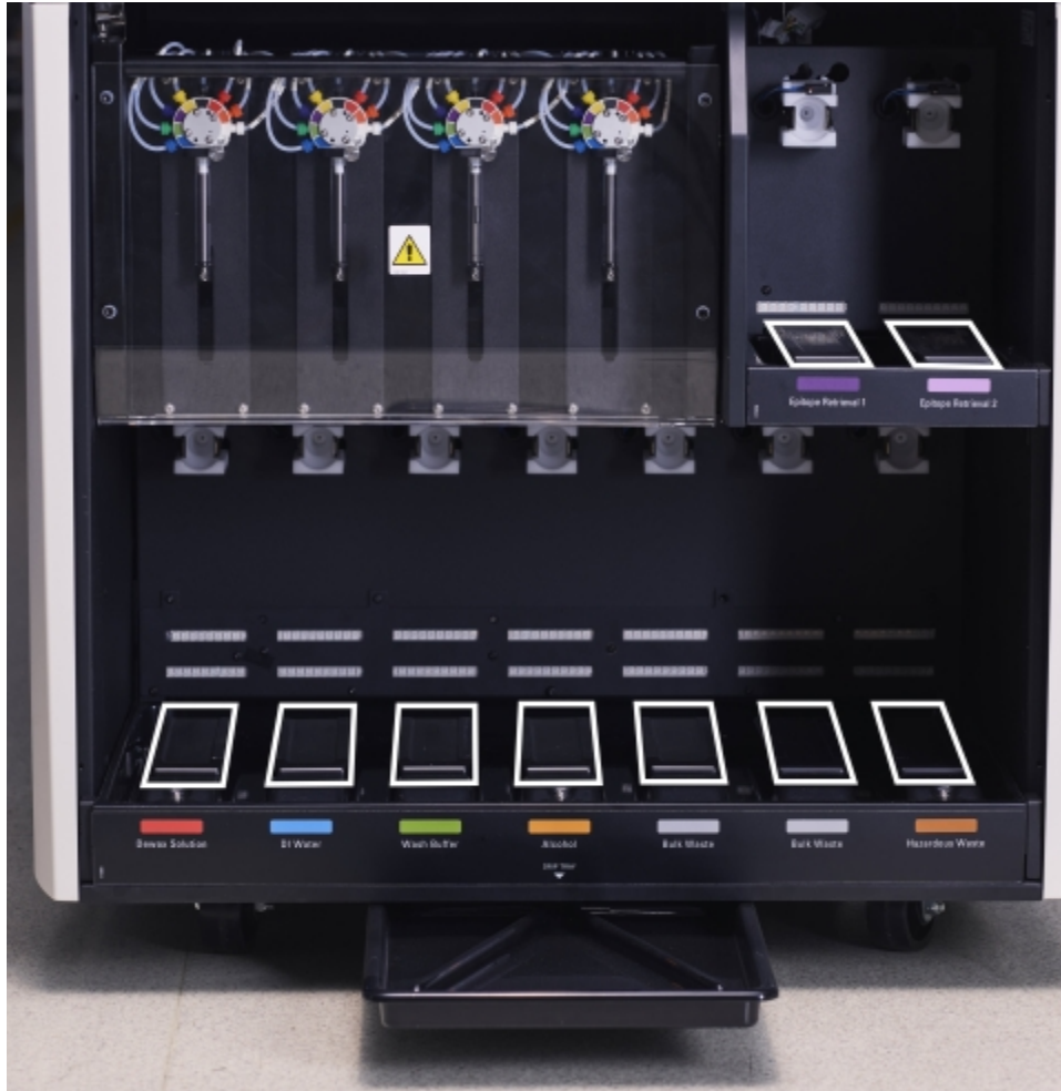
Figura 12-13: BOND-III bandejas de proteção mostrando as coberturas dos sensores de peso
