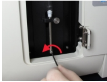
Figura 12-17: Para desparafusar o parafuso da trava da seringa com uma chave hexagonal
