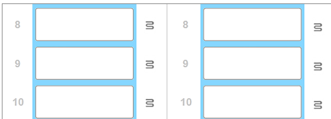
Figura 2-8: Símbolos cinza do bloco de aquecimento em cada posição indicam um completo desligamento do aquecimento
